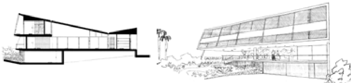
Fig. 06: Corte e Perspectiva, onde é possível perceber o pé-direito duplo do setor social e o fechamento em muxarabi no 1º pav., além da locação de painel artístico no térreo, elaborado em azulejos por Lula Cardoso Ayres. Residência Lisanel de Melo Mota, 1953, Perspectiva. Projeto de Borsoi. Fonte: AMARAL, Izabel.2004.
