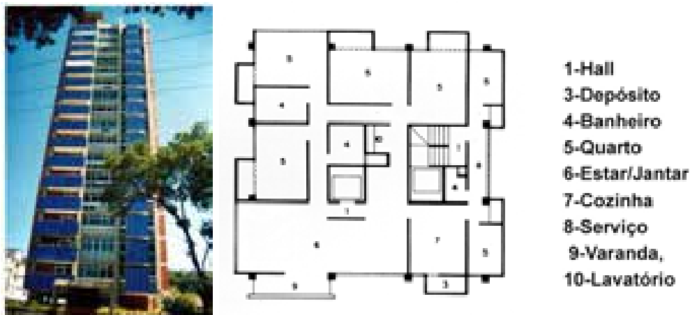
Fig. 66: Foto e pavimento tipo do Edifício Barão do Rio Branco. Projeto Delfim Amorim, 1969. Fonte: GOMES, Geraldo. 1991.
