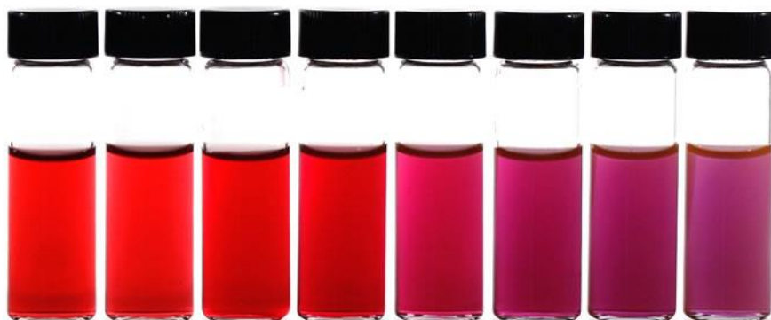
Figura 10 - Nanopartículas de ouro com diferentes tamanhos, variando de 5 a 100 nm.
