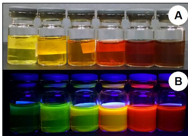
Figura 34. Alíquotas dos PQs de CdTe/CdS-AMP no processo de crescimento das partículas, onde “A” é a aparência das alíquotas em luz ambiente e “B” em luz ultravioleta de 365 nm.
