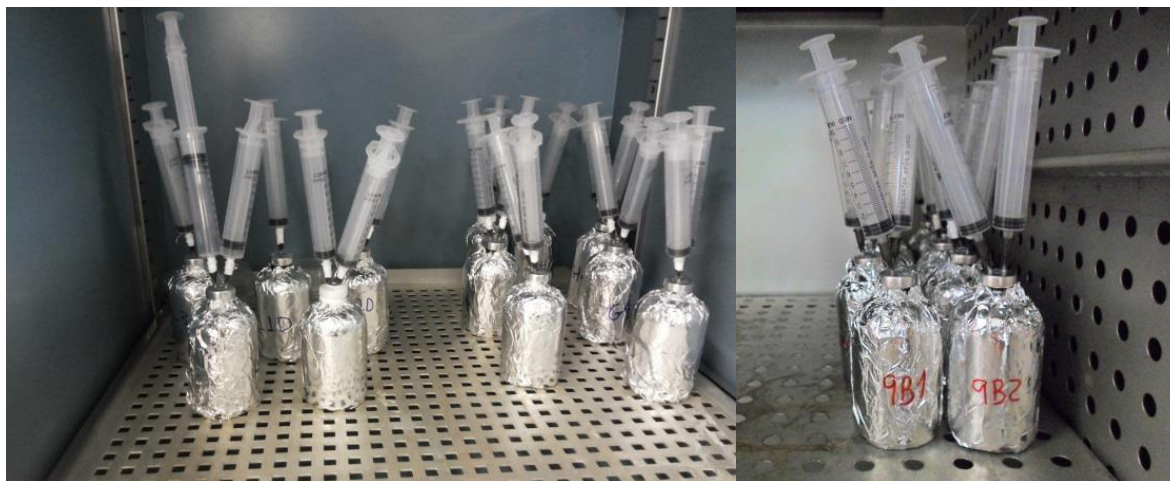
Figura 20 – Reatores anaeróbios em frascos de penicilina
