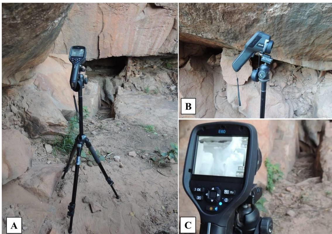
Figura 1. Posicionamento da câmera perpendicularmente à entrada da caverna “Meu Rei” (A), destacando-se sua inclinação em direção à fenda da caverna em uma visão lateral da câmera (B) e o ângulo de visão abrangido nas imagens (C).
