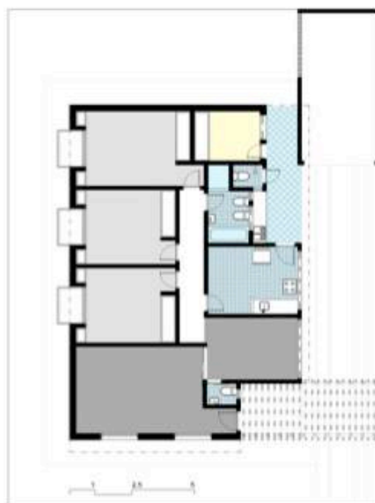
Fig. 6.15 : Projeto-tipo 22-67 (OF) e as estratégias de proteção climática de recuo das janelas em fachada e planta baixa. Projetado por Pedro Flávio Gavitano. Fonte: projetos coletados nos arquivos militares da CRO-11 (dez-2012). Nota: planta baixa redesenhada pela autora.
