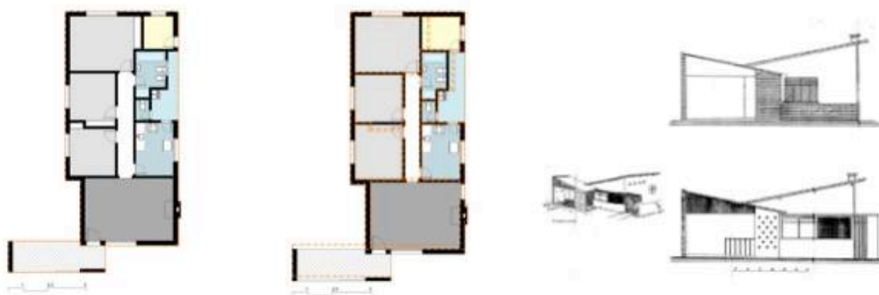
Fig. 6.47: Variações do projeto A-5 para oficiais (115,78m 2 , à esquerda, e 117,75m 2 , à direita). Um dos projetos A-5 foi também codificado como 11-58 e destinava-se para a cidade de Livramento (planta baixa à esquerda). Cada proposta apresentou sua fachada própria, que se assemelhavam entre si, uma vez que segulam as regras gerais de composição (volumes e telhados), mas se diferenciam com os revestimentos dos materiais.
