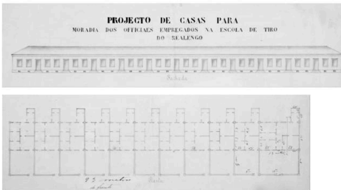
Fig. 3.16: Projeto de um conjunto de casas para oficiais da Escola de Tiro do Realengo, de 1881. Reparar o esquema configuracional característico do século XIX com corpo principal e puxado. Também deve-se observar que o conjunto é formado por 10 casas iguais (com dimensões padronizadas) mais uma casa com maior área por ser mais larga (casa da extrema direita).
