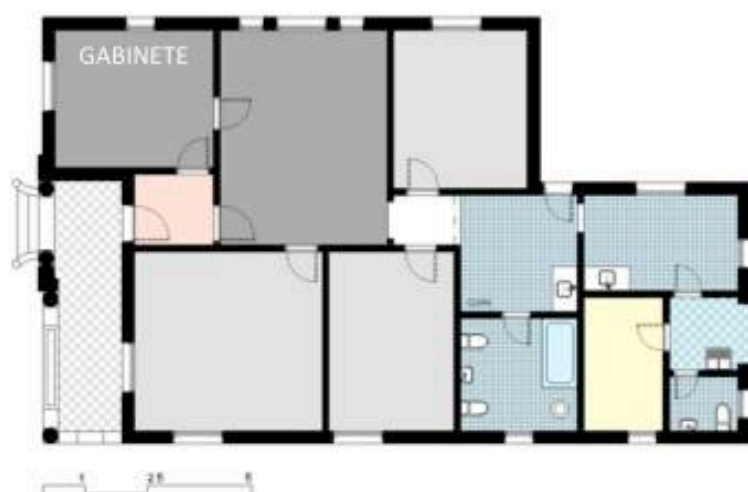
Fig. 3.35: Casa de 1940 (152,94 – 156,57m 2 ) com as duas possibilidades de planta baixa e respectiva fachada. Reparar que a versão superior é uma forma mais compacta, inserida num retângulo, ao passo que a versão inferior é a variação da proposta, com uma configuração baseada na espacialidade do século XIX, do corpo principal e do puxado, além de um corredor quadrangular. Fonte: CRO-3 (Comissão Regional de Obras-7) (coletado em out-2012). Nota: projeto redesenhado pela autora.
