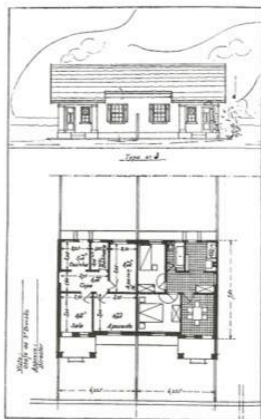
Fig. 6.34: Projeto das casas para os operários da Estrada de Ferro Sorocabana, projetado por Bruno Simões Magro. Perceber a variação da coberta da varanda (destacado com a seta), assemelhando-se à proposta de variação do código D102-53.
