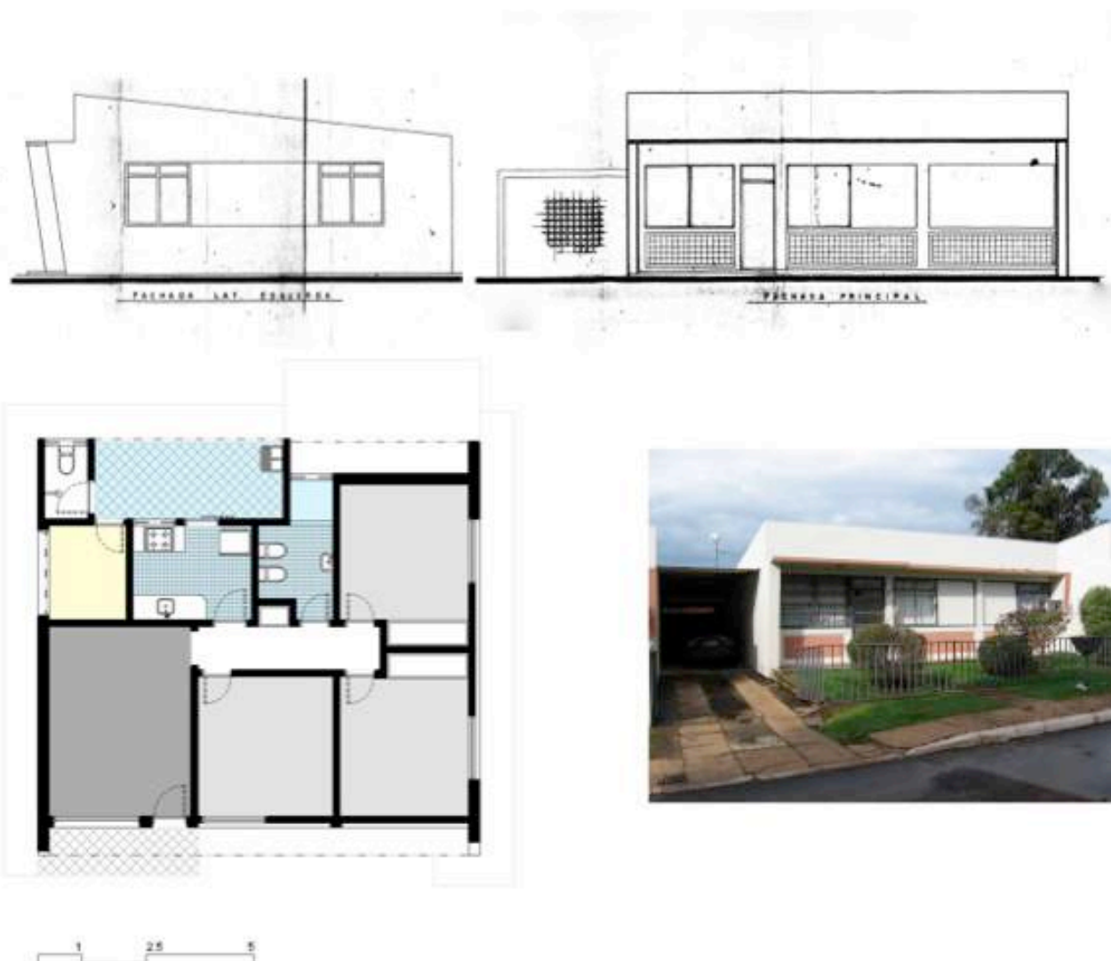
Fig. 6.29: Projeto-tipo 57-67 (SGT) em estilo mais moderno (sup esq; sup dir; inf esq) e a imagem de uma residência para sargentos no Setor Militar Urbano em Brasília, construída seguindo elementos formais semelhantes ao código 57-67 e 21-66 (inf dir). Fonte: projetos coletados nos arquivos militares da CRO-11 (dez-2012); imagem coletada na galeria de imagens do google earth. Nota: planta baixa redesenhada pela autora.
