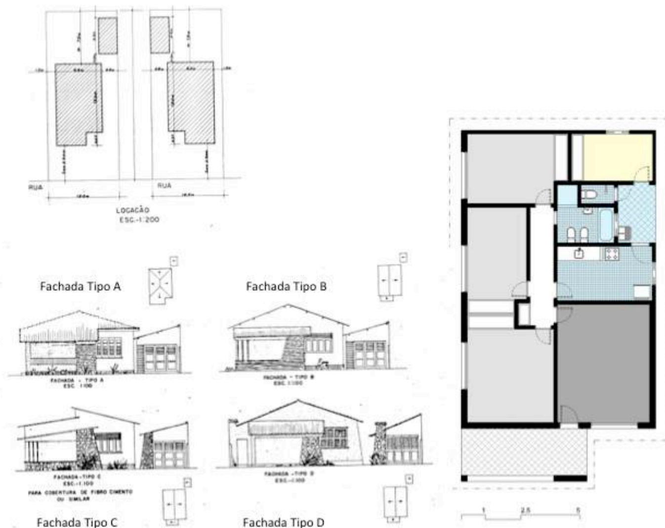
Fig. 6.35: Projeto-tipo 08-65, indicando variações de fachadas e a variação de implantação com unidades espelhadas.
