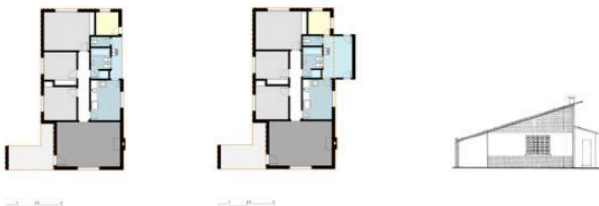
Fig. 6.48: Variações do projeto A-2 para oficiais (114,74m 2 , à esquerda, e 122,62m 2 , à direita). Um dos projetos A-2 foi também codificado como 08-58 e destinava-se para a cidade de Livramento (planta baixa à esquerda). As propostas apresentaram praticamente a mesma fachada.
