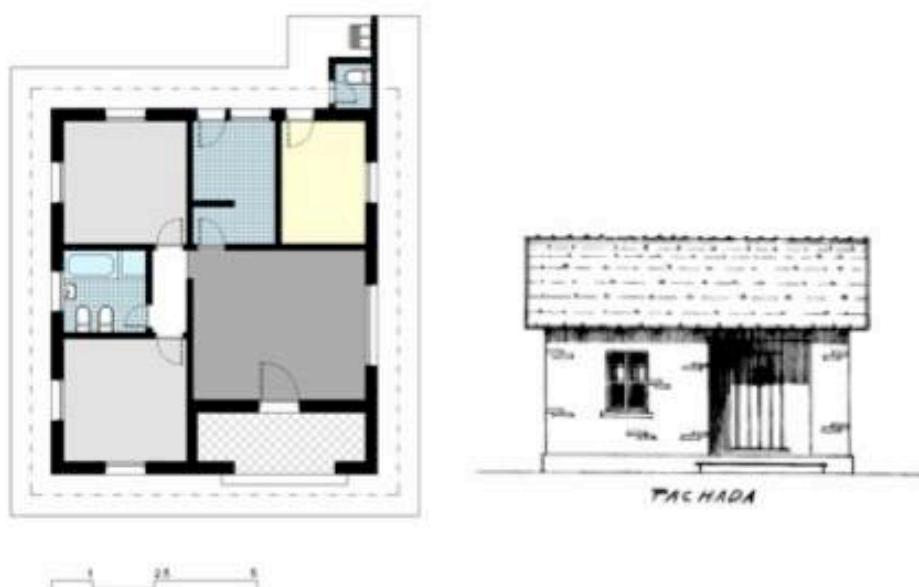
Fig. 3.30: Casa de sargentos, de 1945 (70,75m 2 ), e respectiva fachada. Fonte: CRO-3 (Comissão Regional de Obras-3) (coletado em out-2012). Nota: projeto redesenhado pela autora.
