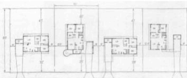
Fig. 2.12: Proposta de variação do standard em Levittown baseada especialmente na orientação e localização da garagem (sup e esq). Esta etapa teve início na primavera de 1952, conforme a matéria. Última imagem abaixo e à esquerda mostra um exemplar em Levittown, de 1949, segundo os princípios definidores do ranch style , segundo Reed (1995). Fonte: Architectural Forum (out-1951); Reed (1995).
