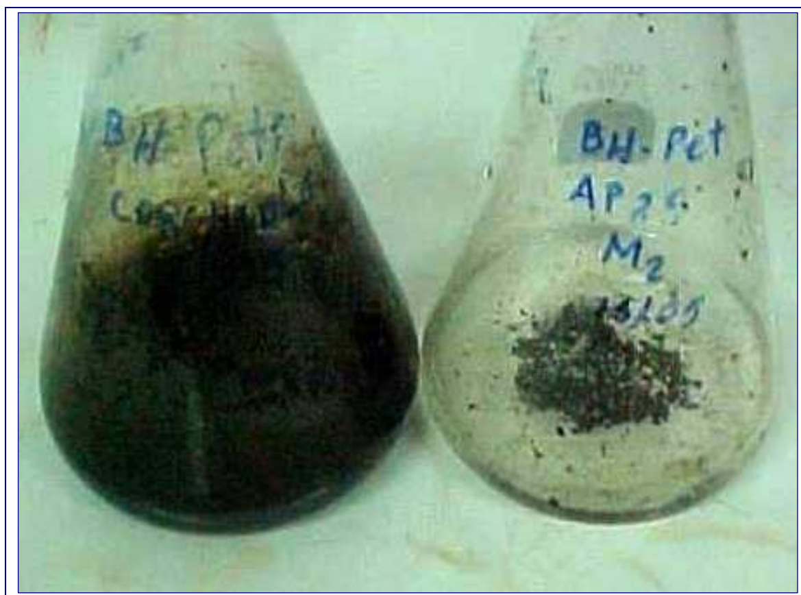
FIGURA – 4. 4 Aspecto macroscópico do ensaio de biodegradação da linhagem DAUFPE –706 (direita), após 20 dias de cultivo em meio mineral (B-H), com 1,0% de petróleo bruto, à temperatura de 30°C e sob agitação de 200rpm. (À esquerda a amostra controle, sem o inoculo).
