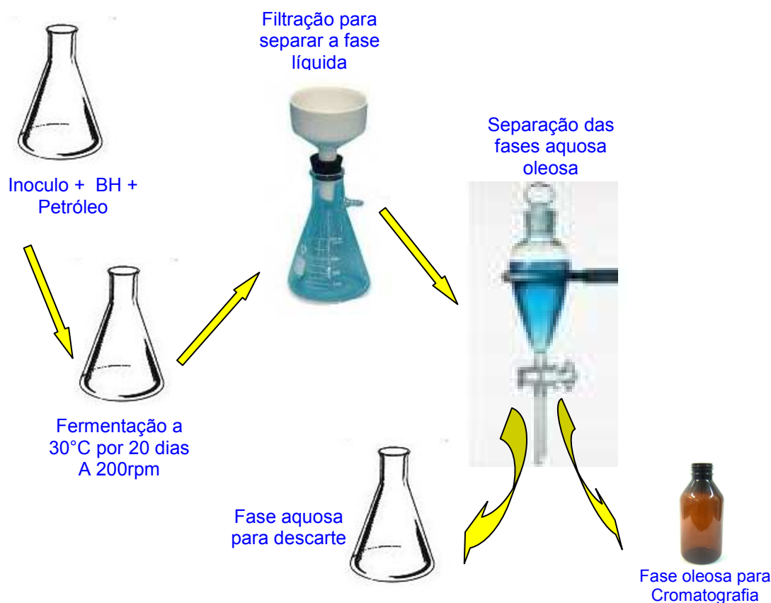
FIGURA – 3.3, Separação da fase oleosa, remanescente para análise cromatográfica, pós a fermentação, em frascos agitados.
