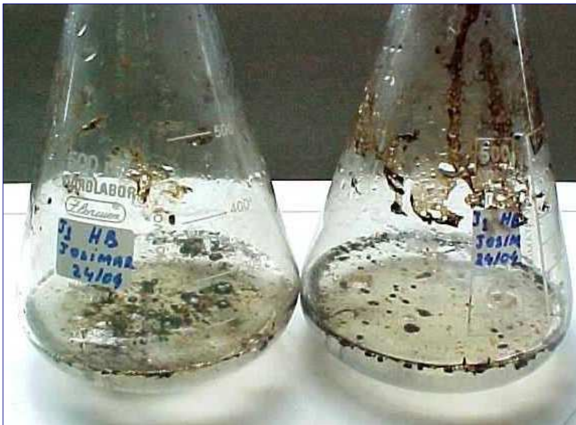
FIGURA – 4. 5 Aspecto macroscópico do ensaio de biodegradação da linhagem DAUFPE – 736, após 20 dias de cultivo em meio mineral (B-H), com 1,0% de petróleo bruto, à temperatura de 30°C e sob agitação de 200rpm. (Em duplicata)
