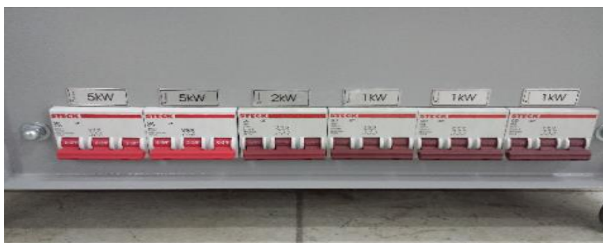
Figura 28 – Banco de resistores para solicitação de potência da carga
