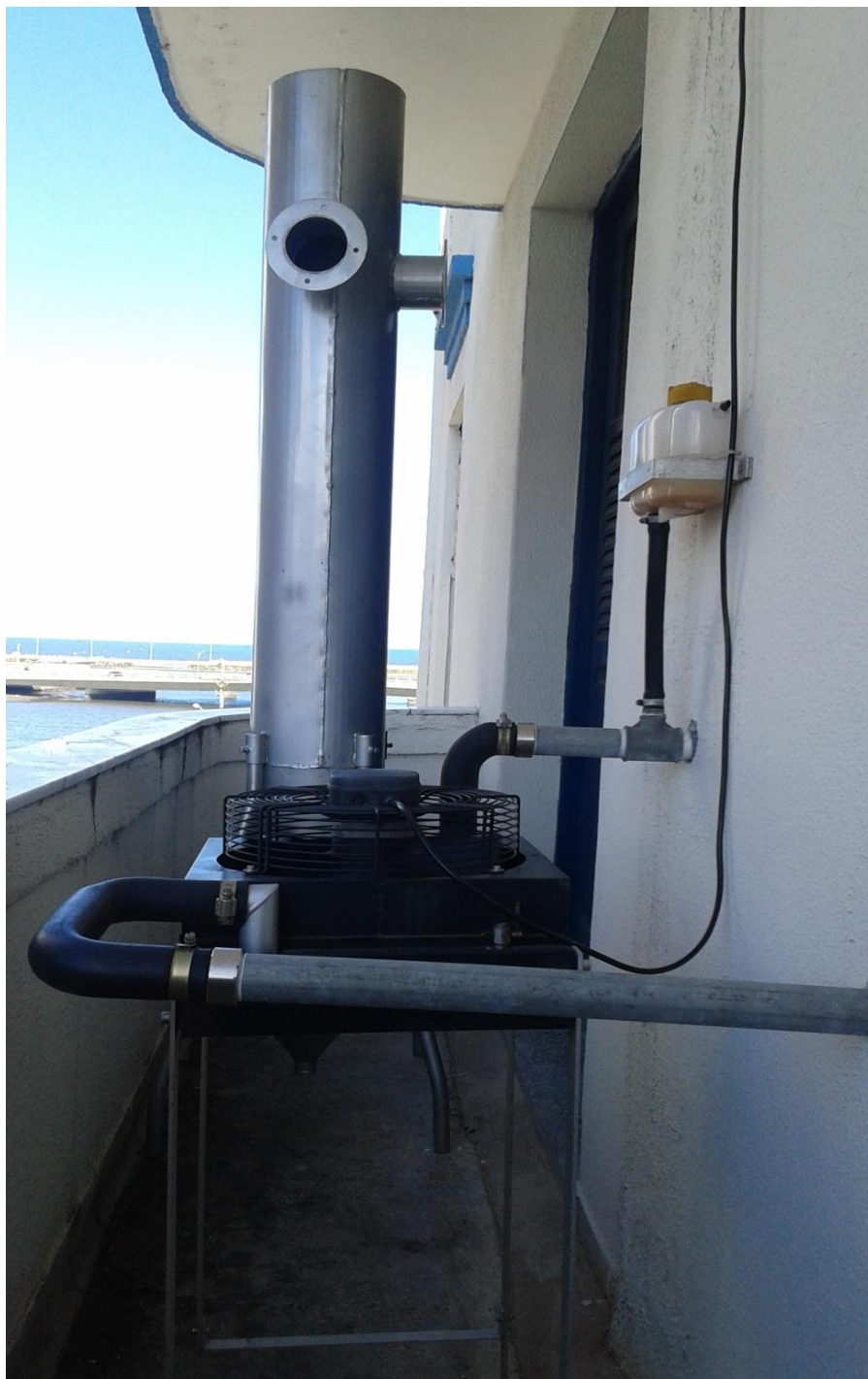
Figura 23 – Chaminé do sistema de análise do grupo gerador diesel
