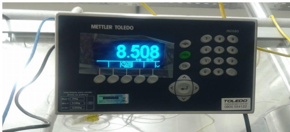
Figura 29 – Balança para medição da massa de combustível consumida
