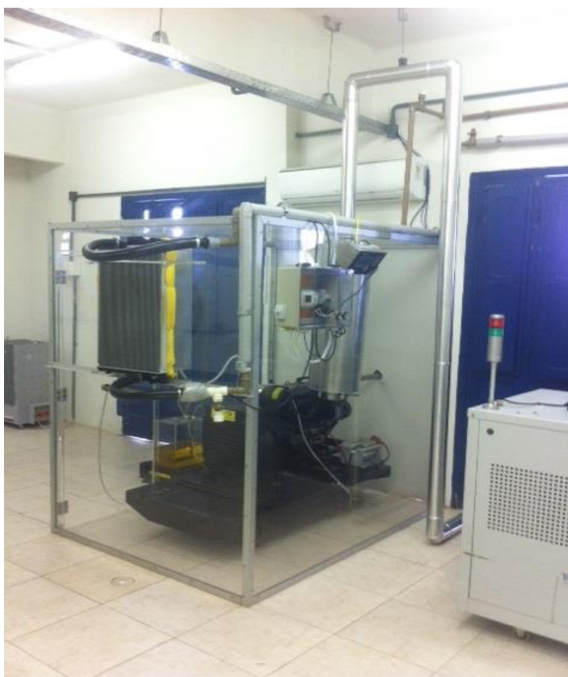
Figura 41 – Vista parcial do arranjo experimental de bancada das instalações do grupo gerador diesel
