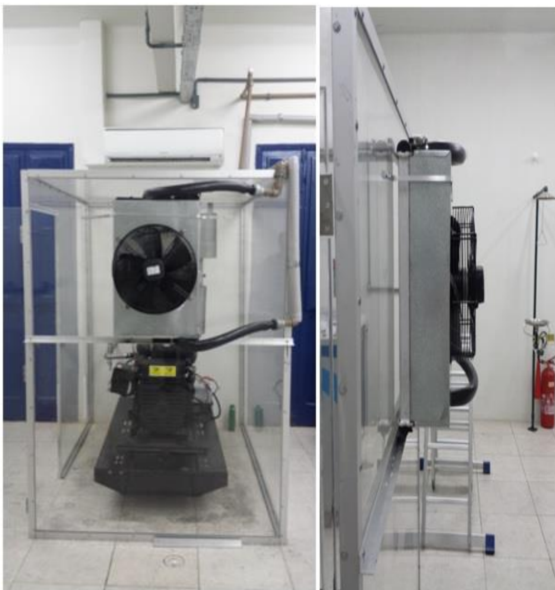
Figura22 – Trocador tipo radiador utilizado no arrefecimento da cabine do conjunto MCI-Gerador
