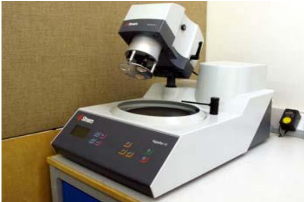
Figura 31 - Prensa para embutimento da marca struers modelo CitoPress-1.
