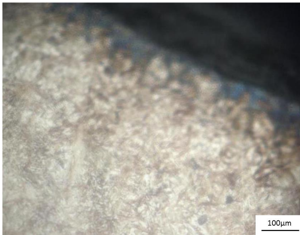
Figura 56 – Microestrutura após o shot peening para condição 4, camada microencruada e mais escura na superfície.
