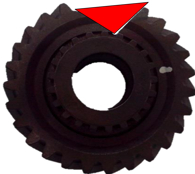
Figura 30 – Primeiro corte para preparação da amostra para caracterização de microestrutura e microdureza antes do processo de shot peening.
