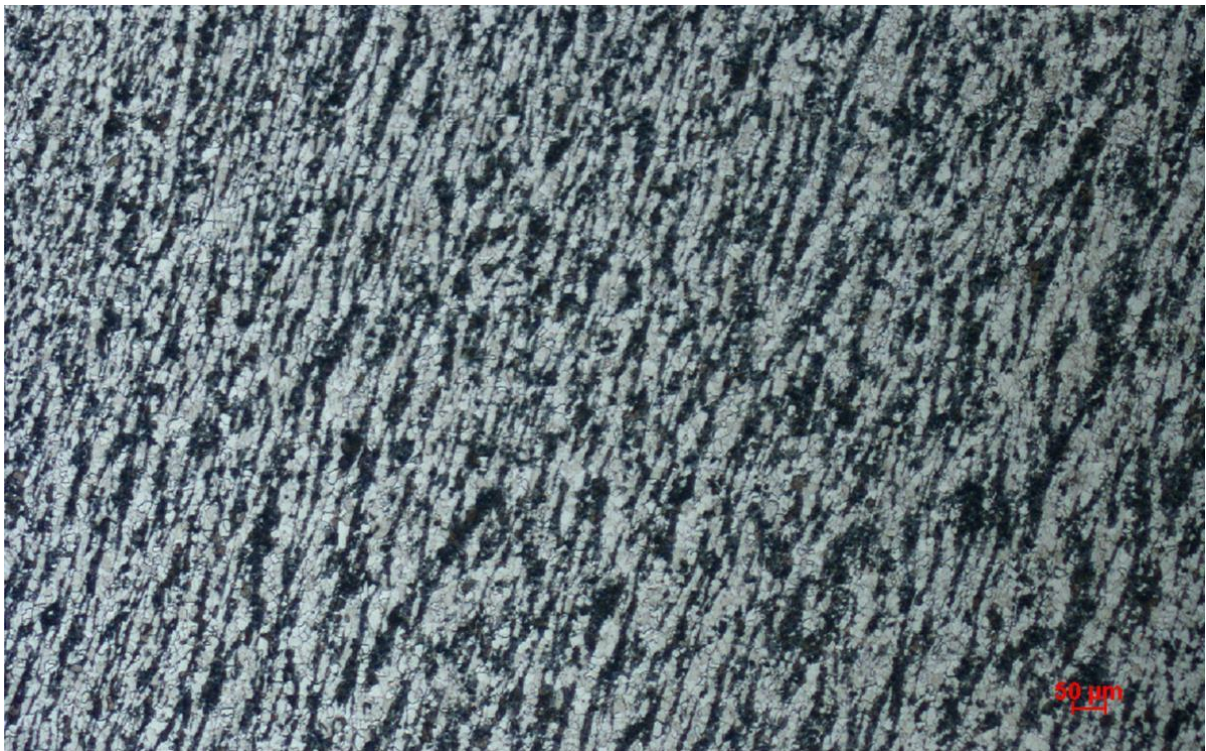
Figura 16 – Microestrutura do forjado conforme fornecido.
