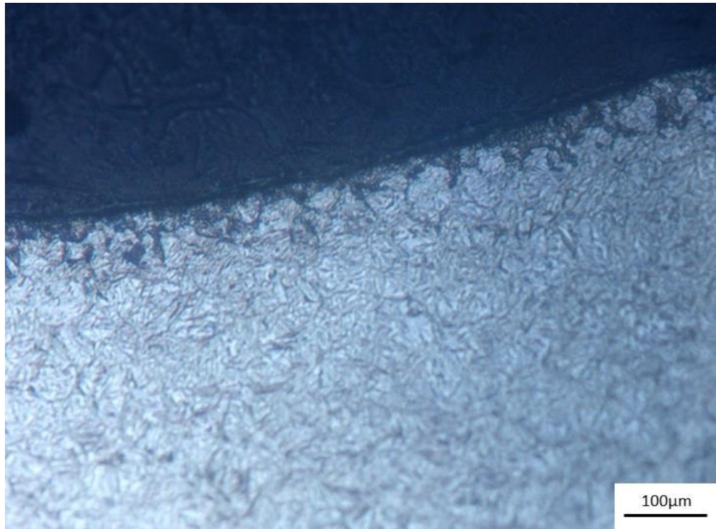
Figura 54 – Microestrutura após o shot peening para condição 2, camada microencruada e mais escura na superfície.
