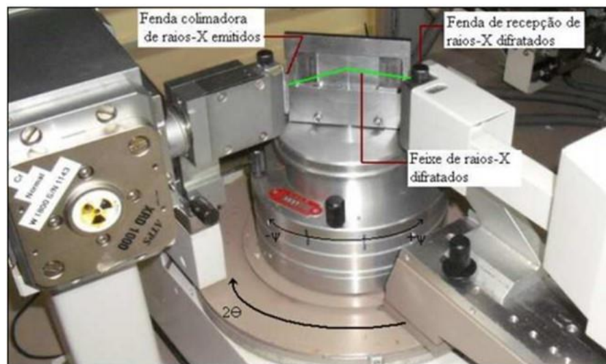
Figura 40 – Dispositivo utilizado por Oliveira, 2011 para medição de tensão residual similar ao utilizado para medição das amostras neste trabalho.
