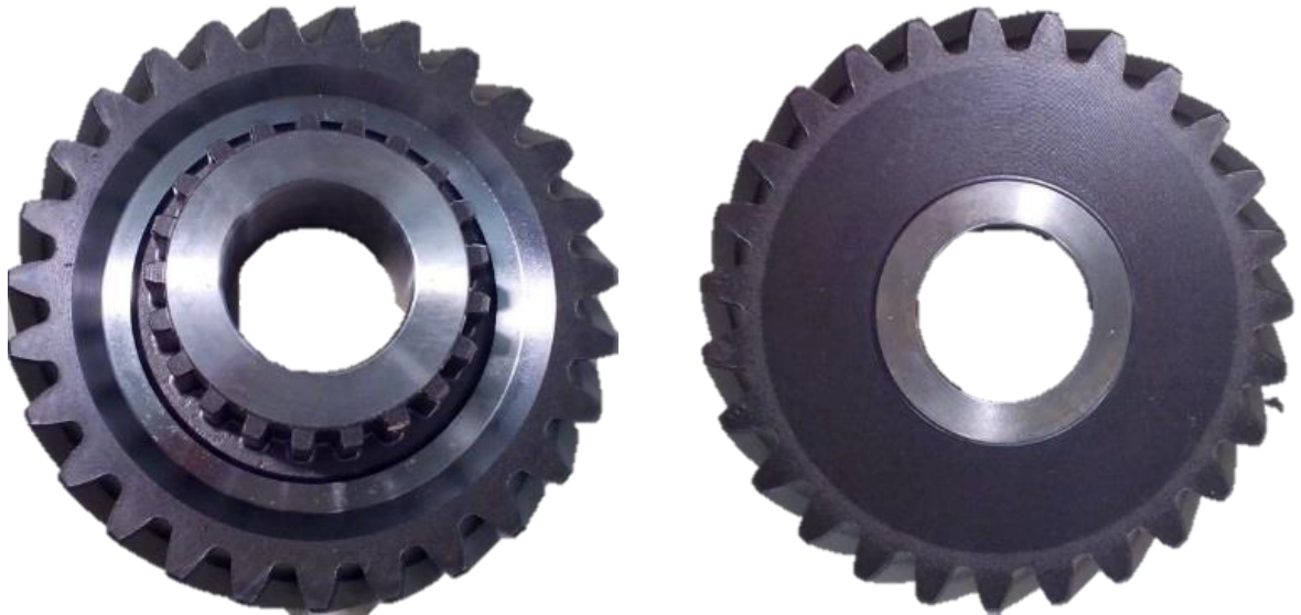
Figura 17 – Corpo de prova após o processo final de acabamento com operação de shot peening. (AUTOR)
