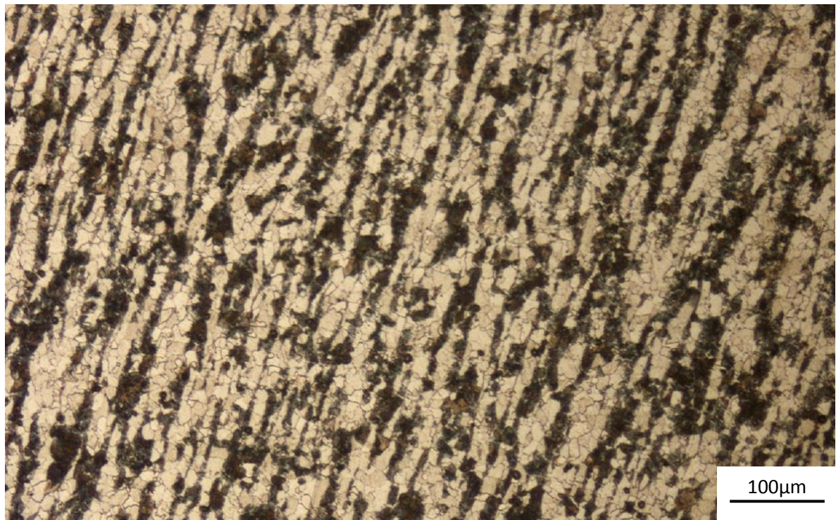
Figura 44 – Microestrutura ferrítica e perlítica da pré-forma forjado após o processo de normalização.
