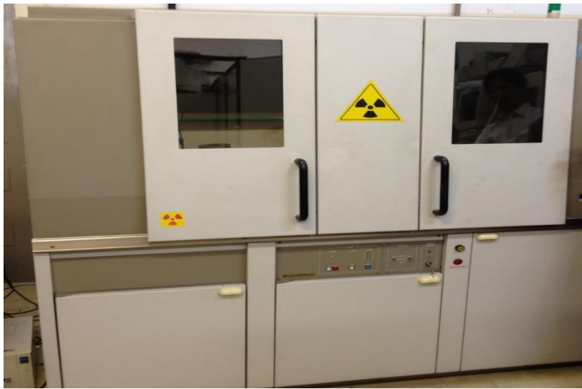
Figura 39 - Difratorômetro de Raio-X Rigaku RINT 200 pertencente ao IPEN/CNEN-SP.
