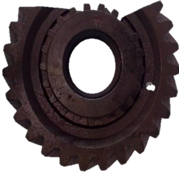
Figura 36 - Retirada do segundo corpo de prova para tensão após shot peening.
