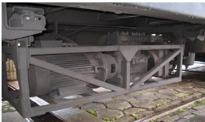
**Figura 4.11:**Conjunto motor-compressor instalado no TUE [8].
