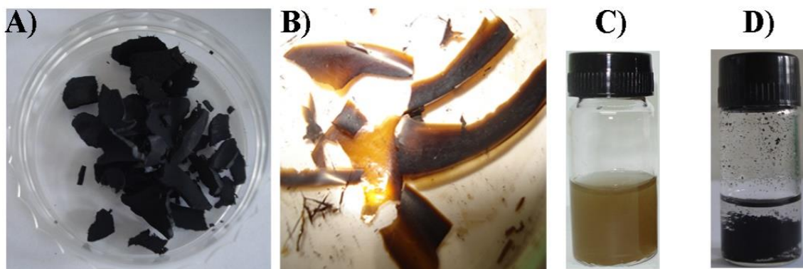
Figura 4.1. Imagens dos nanotubos múltiplas camadas e das fitas oxidadas e reduzidas. A) “Carpet” de nanotubos de carbono de multicamadas. B) Nanofitas oxidadas. C) Dispersão das nanofitas oxidadas em água. D) Dispersões de nanofitas reduzidas em água.
