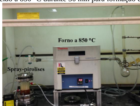
Figura 2.7. Equipamento do spray-pirólise CVD. A dispersão de Tolueno/Ferroceno é colocada no spray e este é conectado a um tubo de quartzo aquecido a 850 °C durante 30 min para formação de MWCNTs.
