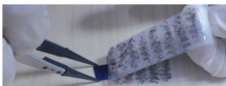
Figura 1.16. O processo de obtenção de grafeno por clivagem, consiste em esfoliar as folhas do grafite até obter uma folha ou algumas folhas de grafite depois depositados em substrato de silício. (Figura reimpressa da referência 48).
