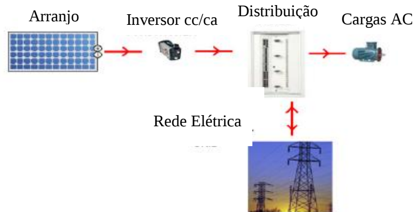
Figura 12 – Diagrama esquemático sistema fotovoltaico conectado a rede elétrica.
