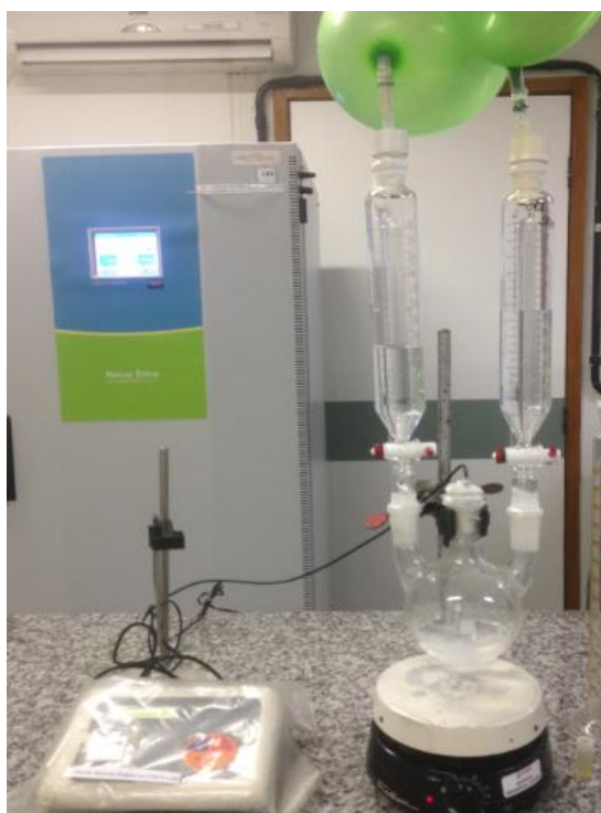
Figura 2 - Síntese por co-precipitação a pH constante do MgAl-Cl-HDL
