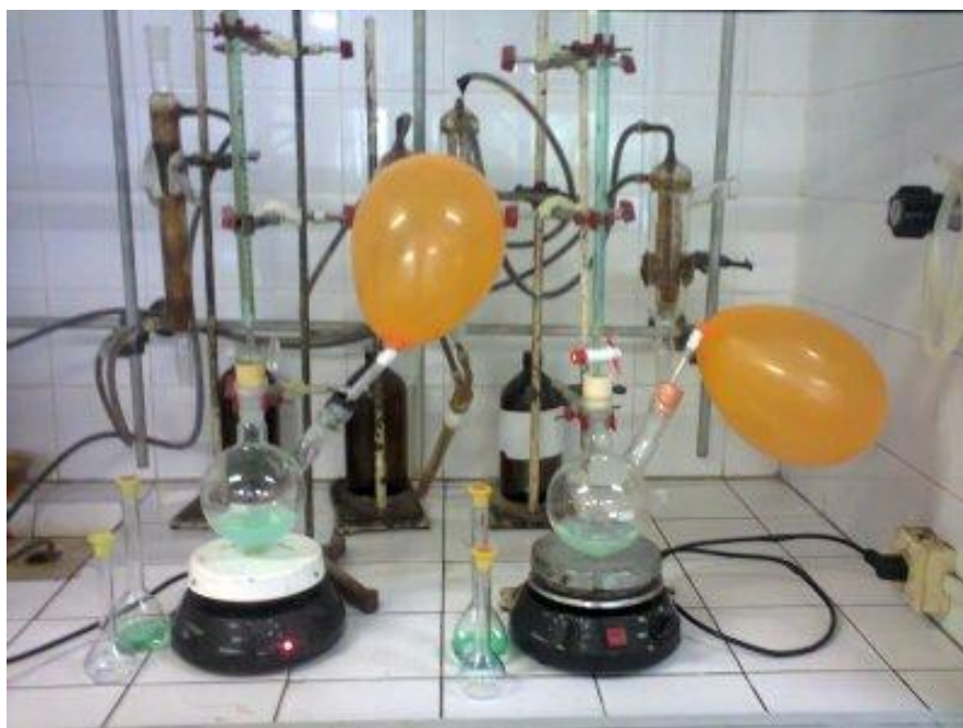
Figura 1 - Síntese por co-precipitação a pH constante do CaAl-HDL
