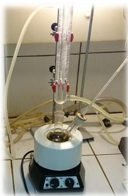
**Figura 10.** Aparato experimental mostrando um único sistema fechado com septos, manta, termômetro e mangueiras do sistema de resfriamento.
