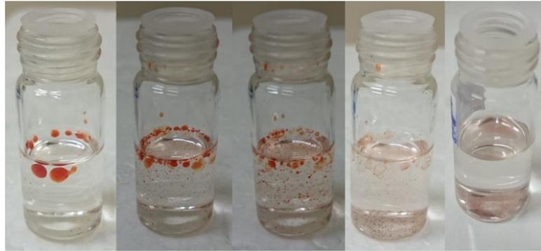
**Figura 35.** Precipitação de material quando adicionado o nanomarcador de CdSe ao etanol combustível com pequenas agitações entre cada fase.
