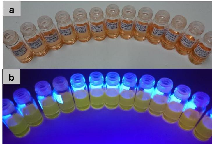
**Figura 28.** Nanomarcadores de CdSe em hexadecano sintetizados em sistema com único reator (a) sem e (b) com incidência da luz UV.
