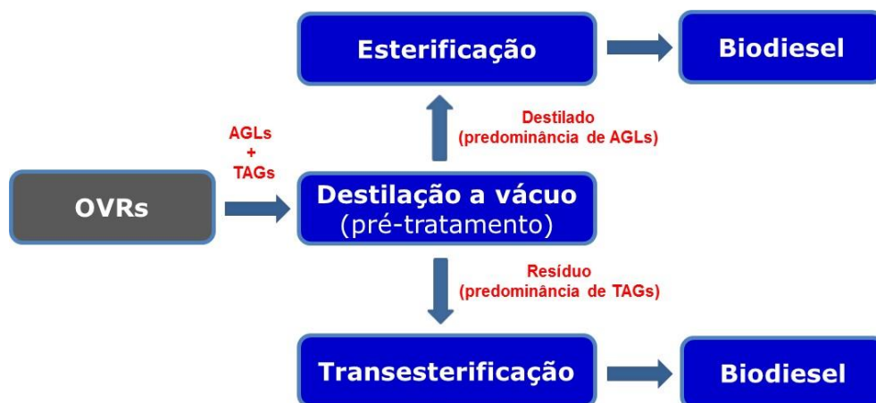
Figura 7 – Visão geral do processo produtivo de biodiesel empregando o pré-tratamento por destilação a vácuo.
