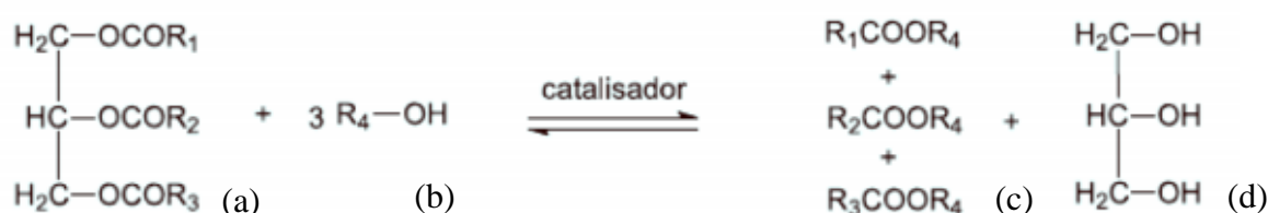
Figura 5 – Reação geral de transesterificação. (a) triacilglicerol, (b) álcool, (c) ésteres graxos (biodiesel) e (d) glicerol. R 1 , R 2 , R 3 e R 4 são radicais alquil.
