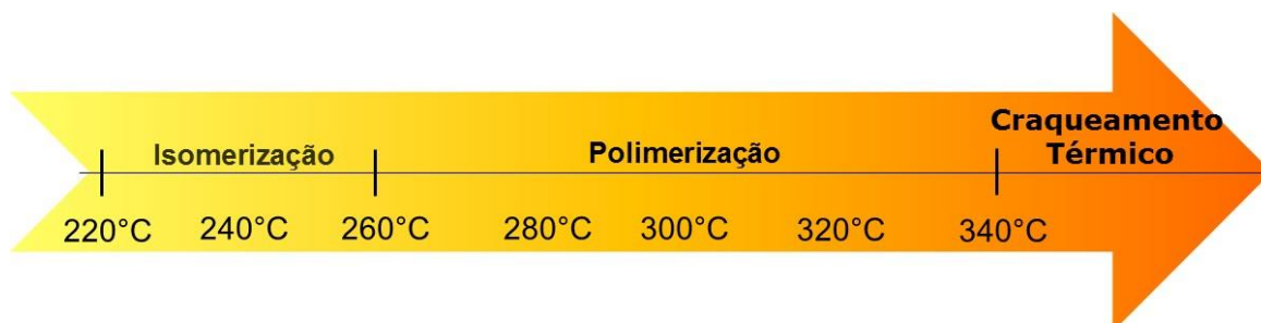
Figura 3 - Faixa de temperatura em que ocorre a degradação térmica de óleos vegetais.
