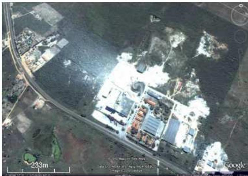
**Figura 4.** Halo de dispersão mecânica de poeira de gesso a partir de unidade de calcinação. Fonte: GOOGLE EARTH (2013).
