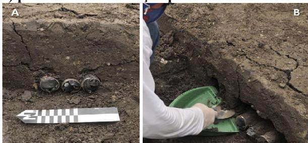
(A) Tubos de PVC utilizados na coleta de sedimentos para datação por LOE. (B) coleta do sedimento ao redor do tubo. Fonte: Imagens cedidas por Demétrio Mützenberg.
