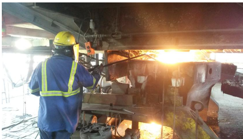
Figura 3.18. Medição manual da temperatura de lingotamento.
