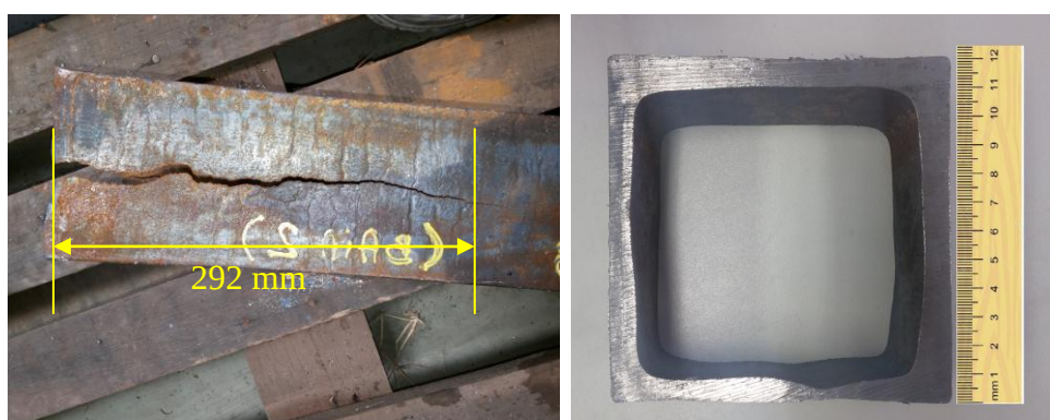
Figura 4.10. Produto do breakout da corrida analisada a) imagem lateral e b) seção quadrada.
