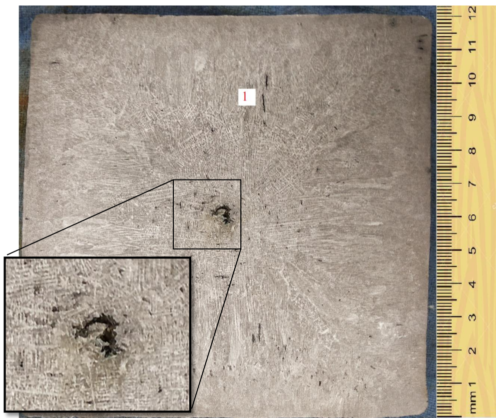
Figura 4.14. Macrografia de amostra da seção transversal de um tarugo da corrida C9. Trinca a meio caminho marcada como 1.
