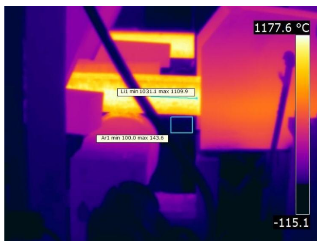
Figura 3.17. Exemplo de termografia realizada na região de radiação livre (imediatamente após o rolo extrator).
