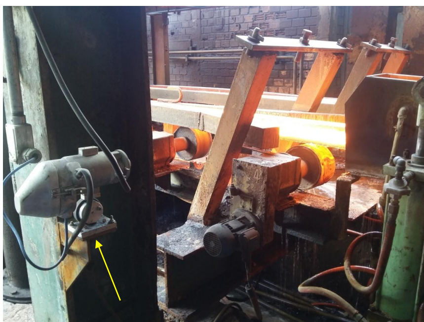
Figura 3.19. Pirômetro ótico posicionado após o rolo extrator.
