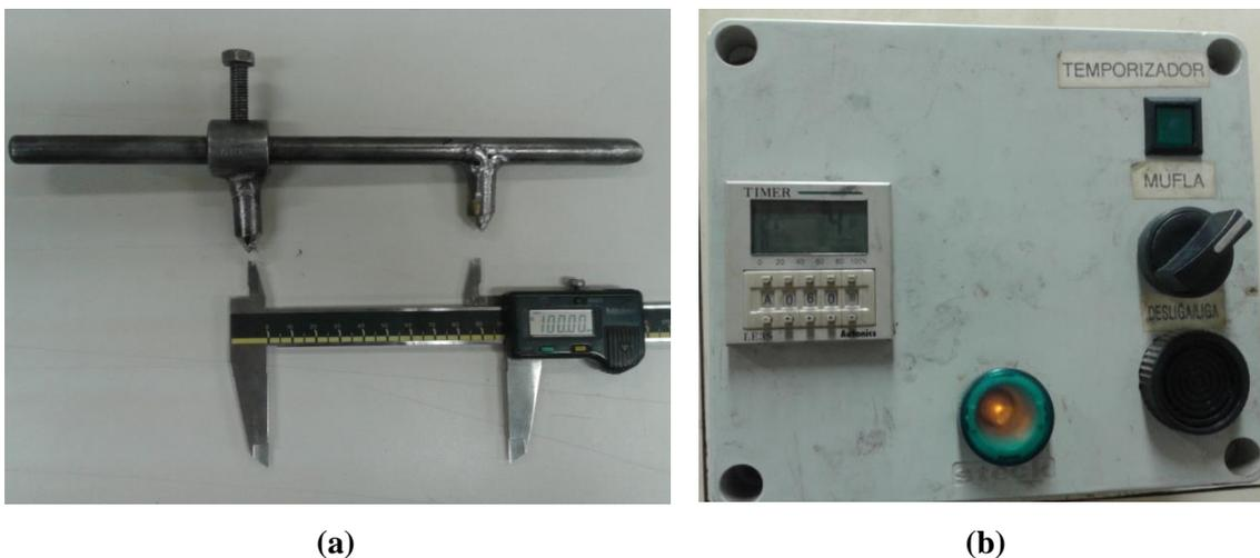
**Figura 54. Aparelhagem para teste de verificação da estabilidade dimensional: (a) Gabarito para marcação de corpos de prova e Paquímetro Digital Capacidade 200mm Resolução 0.01 mm; (b) Relógio temporizador (Mexichem, 2015).**
