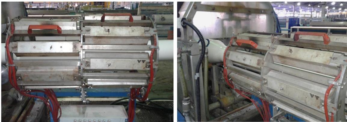
**Figura 17. Unidade de Controle Térmico para Pré-aquecimento de Pré-formas para Orientação Molecular (Mexichem, 2015).**
