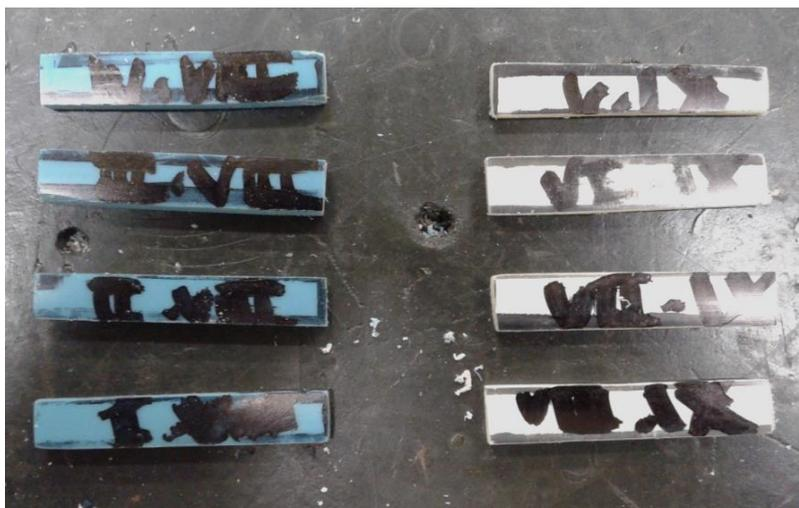
**Figura 70. Separação e identificação dos corpos de prova utilizados no Ensaio de Verificação da Resistência ao Impacto com Pêndulo Charpy (Mexichem, 2015).**
