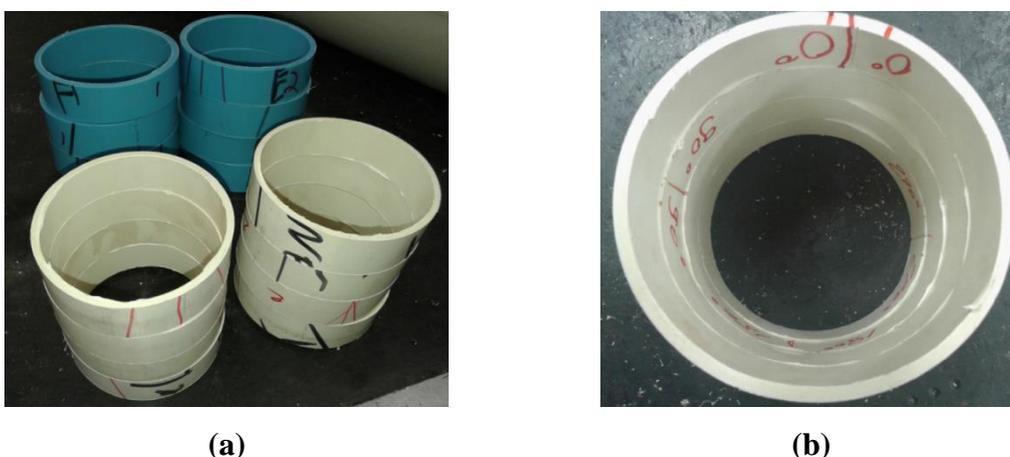
**Figura 61. Preparação dos corpos de prova para o Ensaio de da Resistência ao Prolongamento da Fissura: (a) Corte das amostras em quatro segmentos; (b) Marcação dos ângulos (Mexichem, 2015).**
