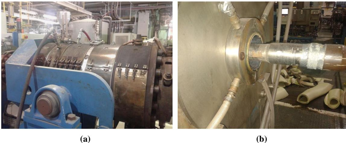
**Figura 10. Zonas de Equalização de fluxo de Massa, Formatação e Calibração em uma Extrusora: (a) cabeçote; (b) calibrador de diâmetro e tanque de calibração (Mexichem, 2015).**
