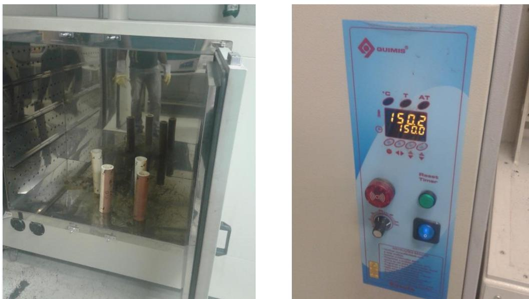
**Figura 47. Separação e acondicionamento em estufa dos corpos de prova com orientação molecular, utilizados no Ensaio de Verificação da Resistência ao Cloreto de Metileno (Grau de Gelificação), com controle de temperatura (Mexichem, 2015).**
