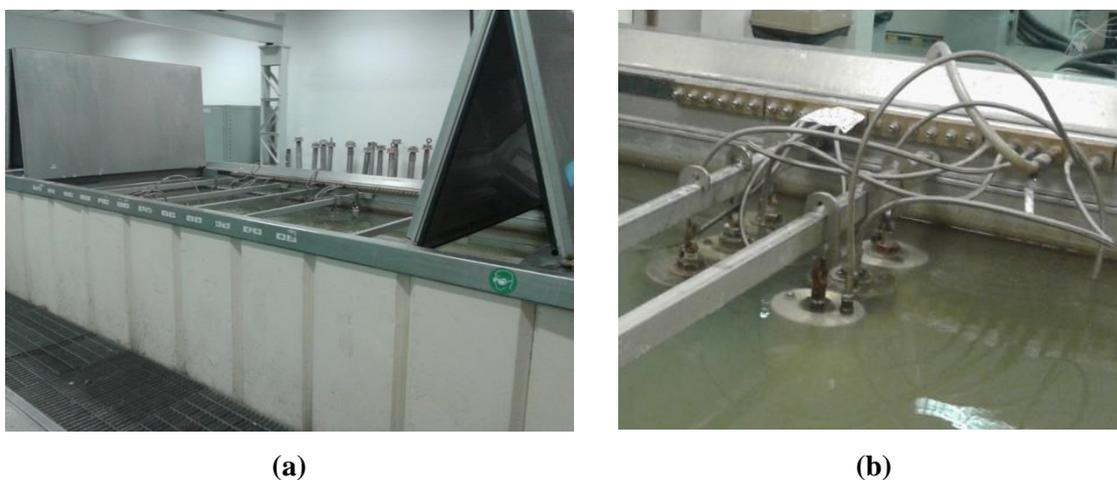
**Figura 41. Aparelhagem para teste de verificação da resistência à pressão hidrostática interna: (a) Tanque de condicionamento com banho termoestabilizado; (b) Equipamento de pressurização com regulador de pressão (Mexichem, 2015).**
