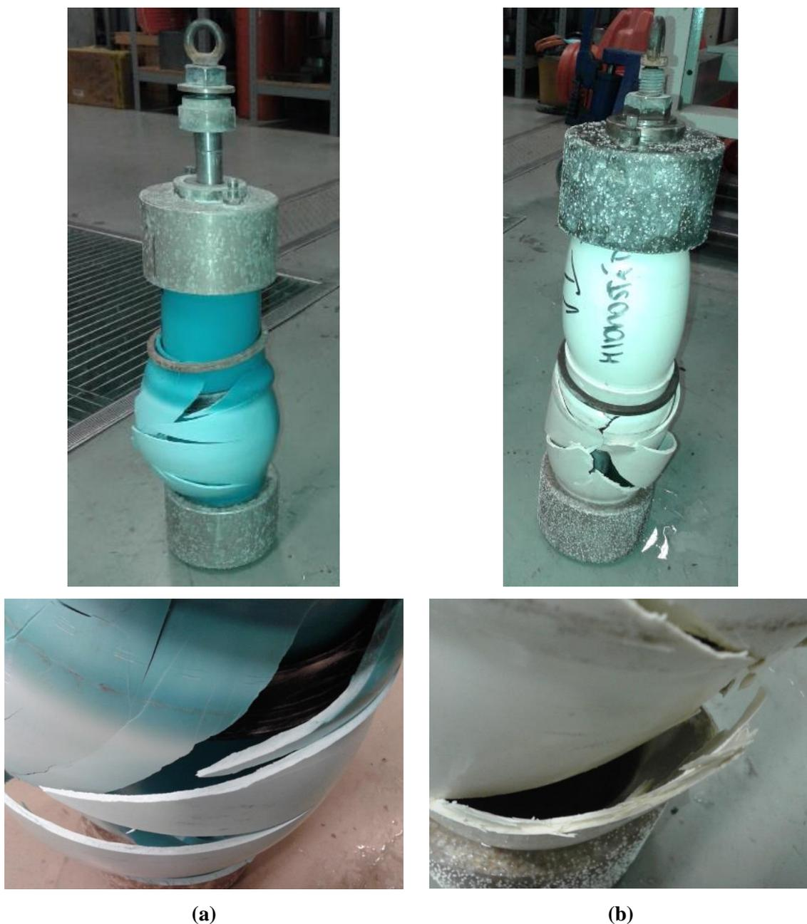
**Figura 79. Avaliações dos corpos de prova após as realizações dos ensaios quanto ao estado estrutural e mecânica da fratura: (a) Tubos sem orientação molecular; (b) Tubos com orientação molecular.**
