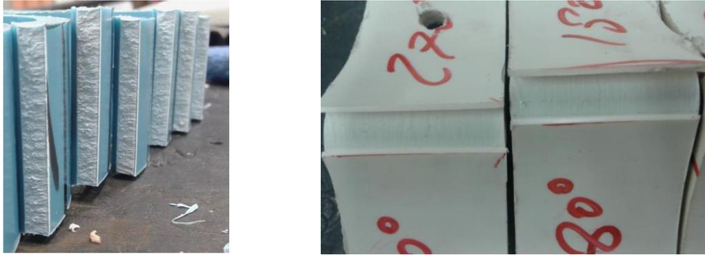
Figura 91. Análises dos aspectos das fraturas após a realização do Ensaio de avaliação da resistência ao prolongamento da fissura: (a) Tubos sem orientação molecular; (b) Tubos com orientação molecular (Mexichem, 2015).
