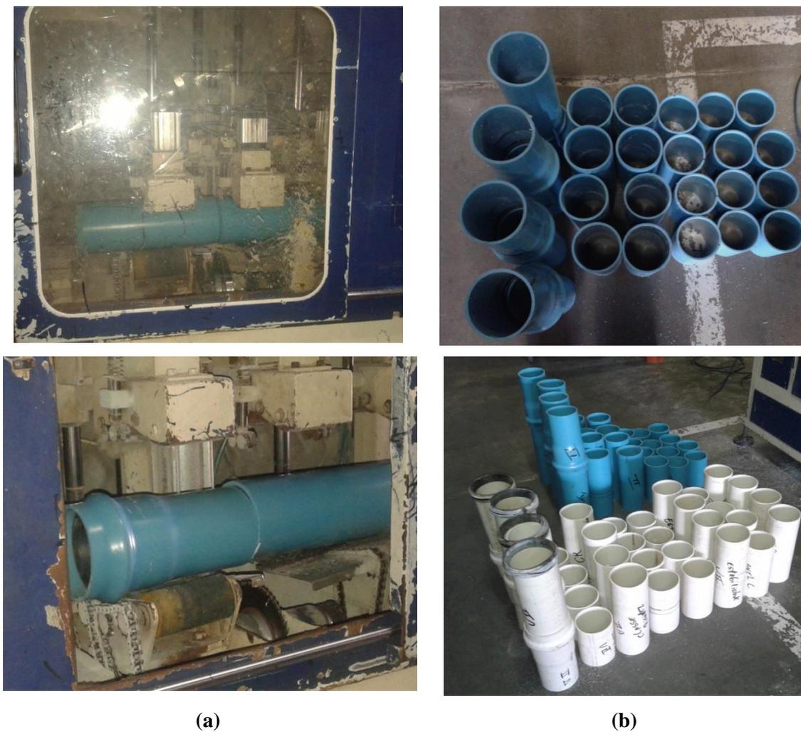
**Figura 31. Confeção e identificação dos corpos de prova: (a) Corte das amostras e confecção dos corpos de prova; (b) Separação e identificação dos corpos de prova (Mexichem, 2015).**
