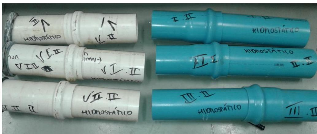
Figura 42. Separação e identificação dos corpos de prova utilizados no Ensaio de verificação da resistência à pressão hidrostática interna (Mexichem, 2015).
