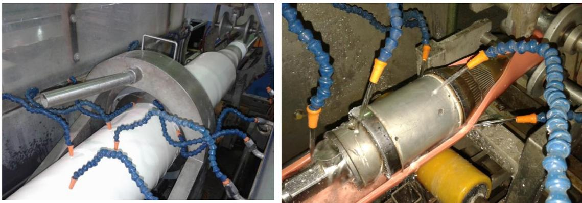
Figura 19. Unidade de Orientação Molecular Biaxial (Mexichem, 2015).
