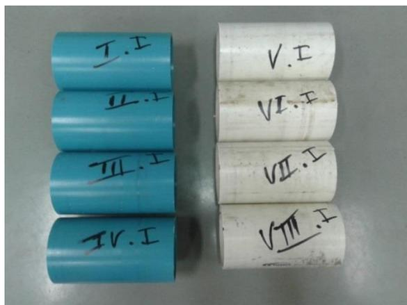
**Figura 33. Separação e identificação dos corpos de prova utilizados no Ensaio de Verificação da Resistência ao Impacto com Percursor Metálico (Mexichem, 2015).**
