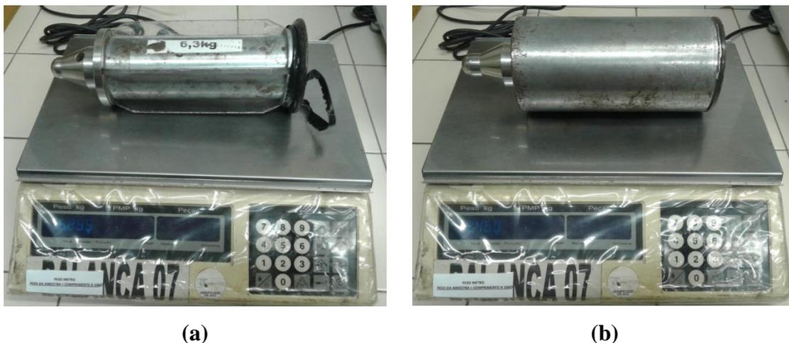
**Figura 38. Medição das massas dos percussores adotados no Ensaio de Verificação da Resistência ao Impacto com Percursor Metálico: (a) Percursor de massa 6,3 Kg; (b) Percursor de massa 12,5 Kg (Mexichem, 2015).**
