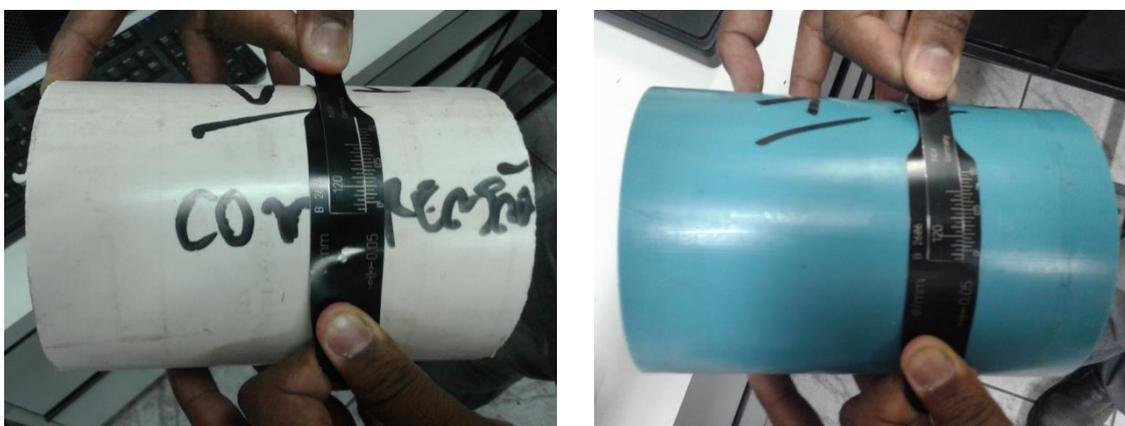
**Figura 51. Conferência de dimensões dos corpos de prova utilizados no Ensaio de Verificação da Resistência à Compressão Diametral (Mexichem, 2015).**
