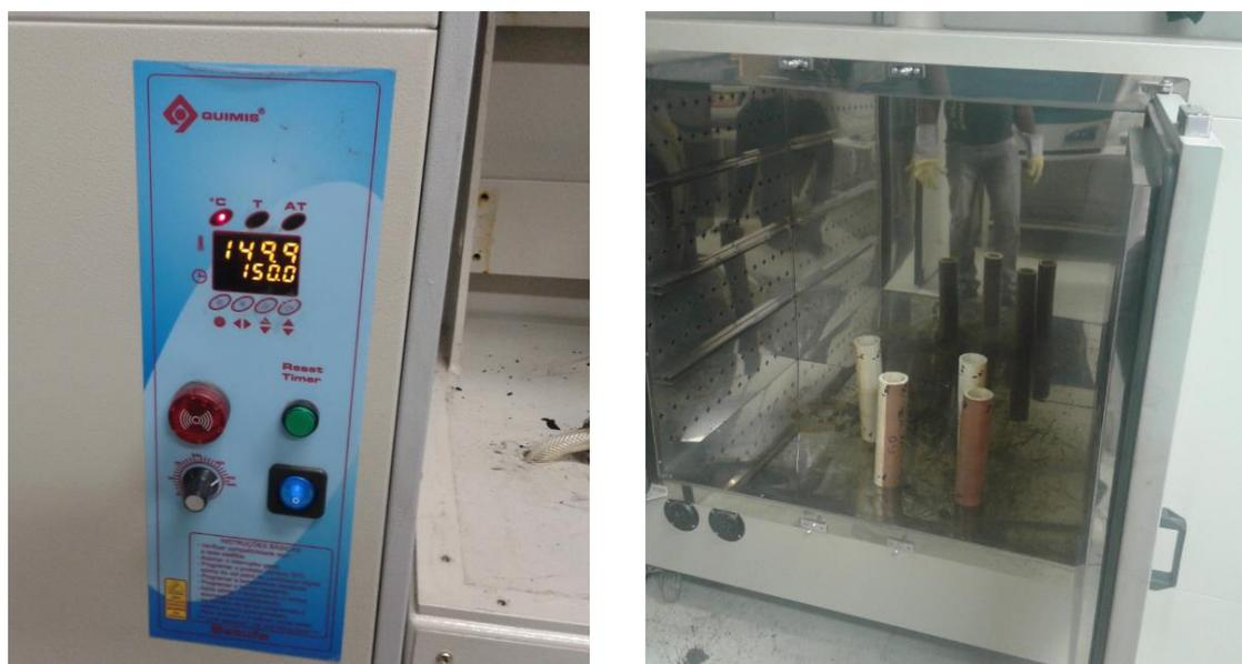
**Figura 67. Inserção dos Corpos de prova utilizados no Ensaio de Grau de Orientação Molecular em estufa microprocessada (Mexichem, 2015).**
