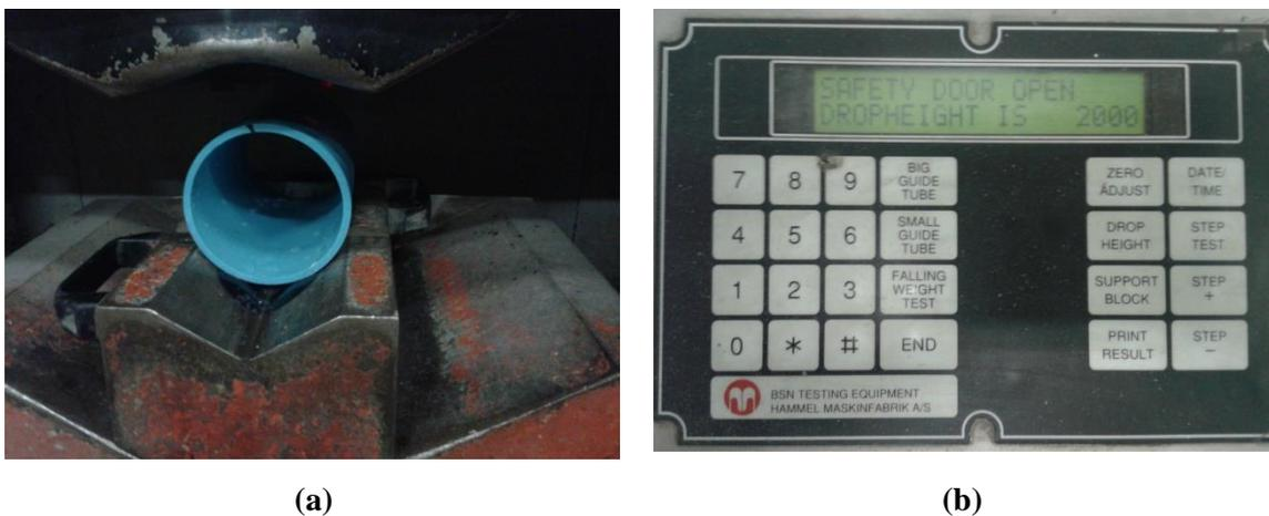
**Figura 39. Ajuste do equipamento para teste de impacto: (a) Posicionamento das alturas dos apoios; (b) Controle da altura de queda (Mexichem, 2015).**
