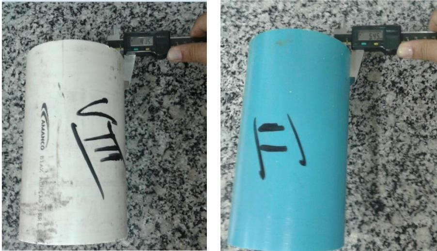
**Figura 34. Conferência de dimensões dos corpos de prova utilizados no Ensaio de Verificação da Resistência ao Impacto com Percursor Metálico (Mexichem, 2015).**
