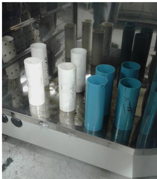
**Figura 56. Posicionamento dos corpos de provas utilizados no Ensaio de Verificação da Estabilidade Dimensional em estufa microprocessada (Mexichem, 2015).**
