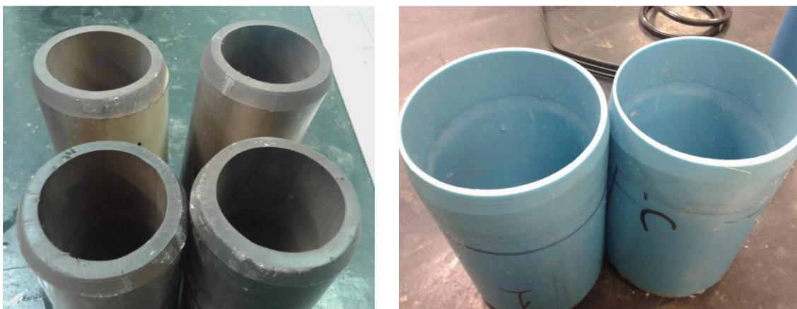
**Figura 48. Confecção de chanfros nos corpos de prova utilizados no Ensaio de Verificação da Resistência ao Cloreto de Metileno (Grau de Gelificação) (Mexichem, 2015).**
