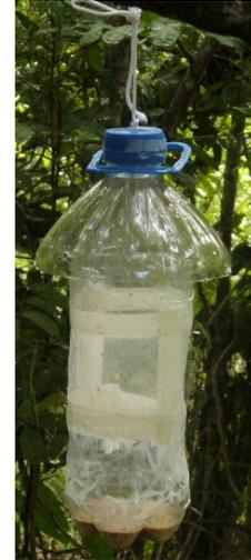
**Figura 5.** Imagem de uma caixa de população, elaborada para a exposição de drosofilídeos aos ambientes de estudo, confeccionada com garrafa PET transparente, tela fina, meio de cultivo no seu interior e uma cobertura para proteção (VERÇOSA, 2015).
