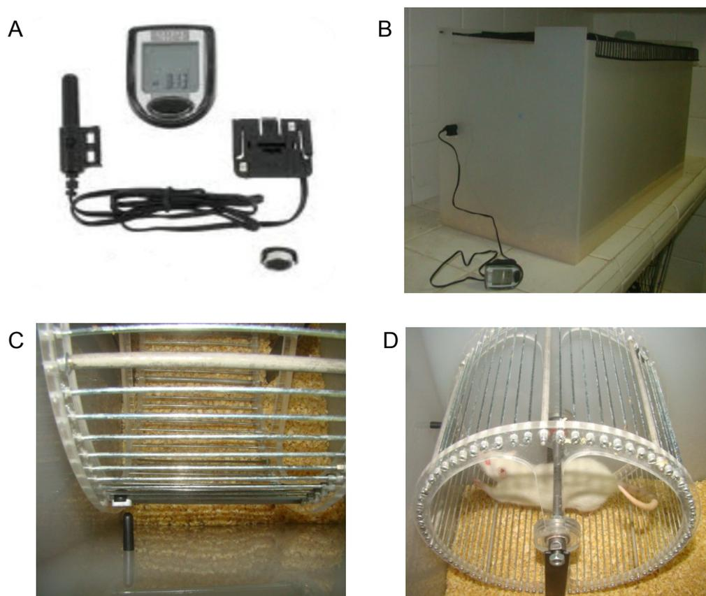
**Nota:** Ciclocomputador com os sensores [Cataye, model CC-VL810, Osaka, Japan] (A); Posicionamento de um sensor na porção externa da GAFV, acoplado ao ciclocomputador (B); visão interna dos sensores, um acoplado ao cicloergômetro e outro a GAFV (C); Rata realizando a atividade física (D).
