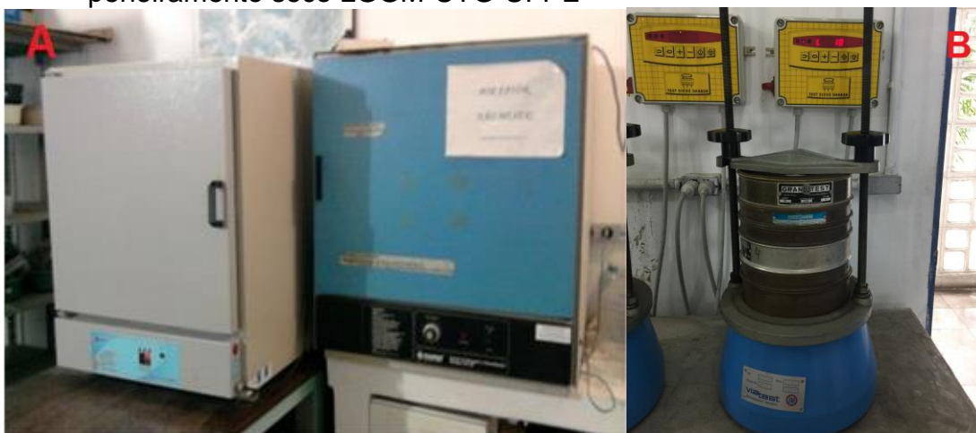
Figura 3 – (A) Estufa para secagem das amostras (B) – Peneiras utilizadas para o peneiramento seco LGGM-CTG-UFPE
