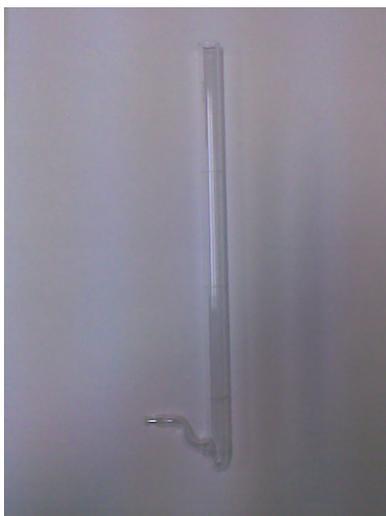
**Figura 4.6** Bolhômetro usado na determinação do fluxo do vapor dos combustíveis.
