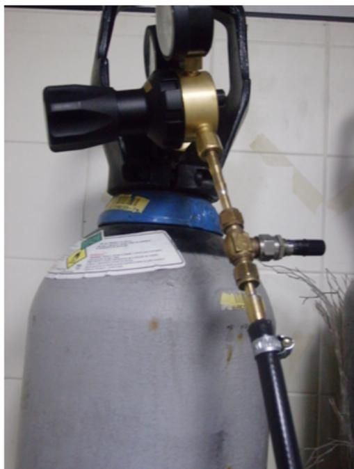
**Figura 4.7** Detalhe da válvula micrométrica conectada à saída do regulador de pressão, usada para regulação da vazão de ar sintético para o *trap* com o combustível, obtendo-se, assim, o seu vapor saturado.
