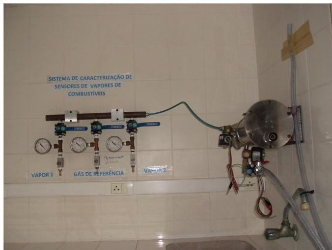
**Figura 3.8** Instalação do sistema de caracterização de sensores de vapores de combustíveis.
