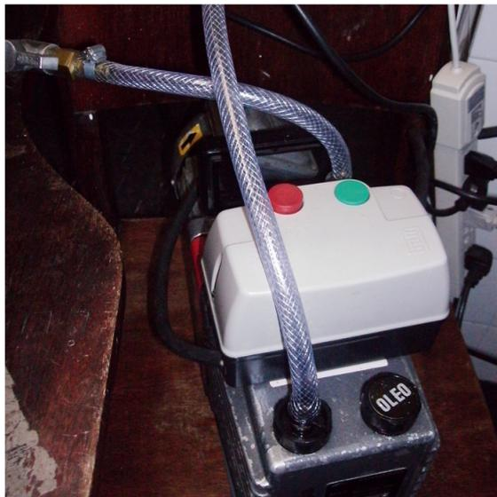
**Figura 3.4** Bomba de vácuo usada no sistema de caracterização de vapores de combustíveis.
