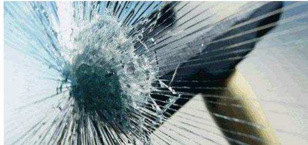
Figura 3.3 Podemos notar que todas as fraturas radiais são determinadas no momento do impacto, e, obedecem à uma distribuição de probabilidade uniforme. Imagem retirada da referência [22]
