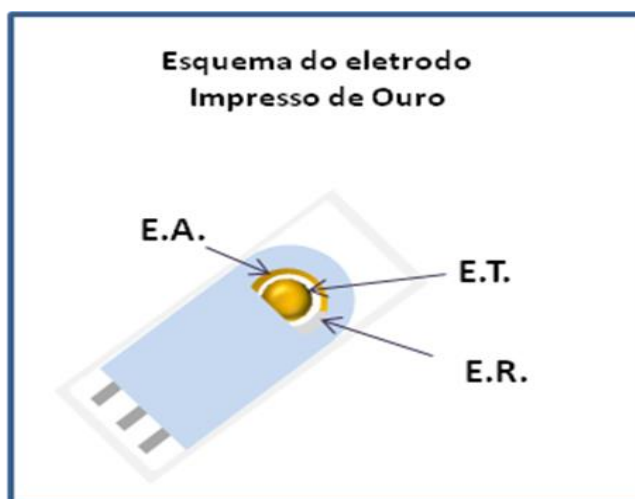
Figura 15: Esquema do eletrodo impresso de ouro. E.A. (Eletrodo Auxiliar), E.T. (Eletrodo de trabalho) e E.R. (Eletrodo de Referência).
