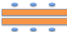
Figura 5- Esquema de moléculas adsorvidas em lamelas de HDL.
