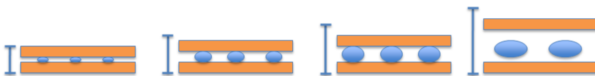
Figura 4- Ânions determinando o espaço interlamelar em HDLs.
