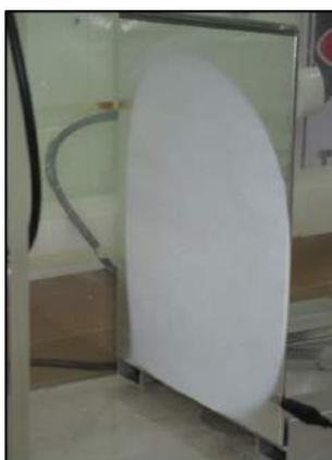
Figura 6.1: Membrana de PS após 4 horas do processo de eletrofição, depositada sobre o coletor.
