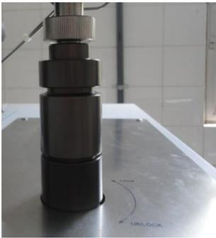
Conexões entre o reator e o removedor de cinzas. Nestas conexões existem anéis de borracha (o-rings) que fazem a vedação do sistema e podem representar vazamento se apresentarem sujeira ou não encaixarem corretamente.
