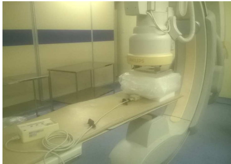
Figura B3 – Arranjo experimental utilizado para o teste da taxa de kerma ar de referência típica e máxima na entrada da pele do paciente
