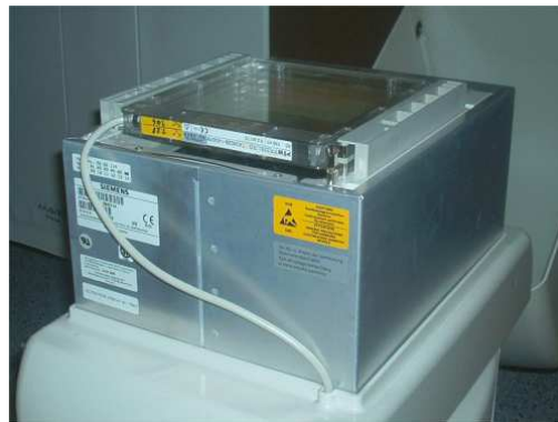
Figura 11 - Câmara de ionização de placas paralelas utilizada para medição do P_{KA}
