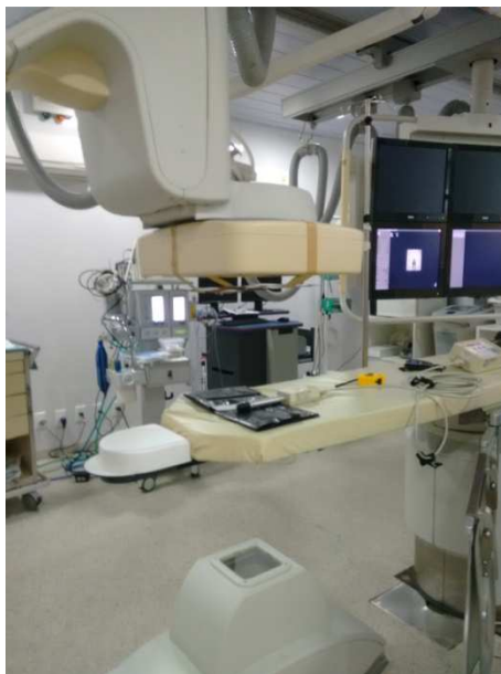
Figura D1 – Arranjo experimental para a determinação do fator de correção da câmara de ionização de placas paralelas do angiógrafo Philips Allura Xper FD 20
