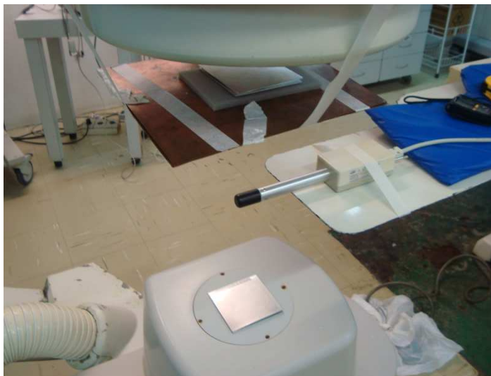
Figura B1 – Arranjo experimental utilizado para o teste da camada semi-redutora
