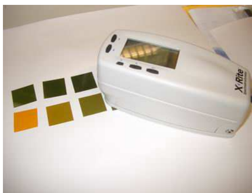
Figura E1 – Medida da densidade de refletância nos filmes radiocrômicos para a construção da curva de calibração
