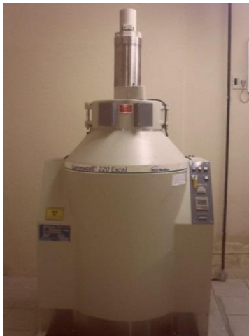
Figura 6 - Irradiador Gammacell com fonte de cobalto-60 utilizado para irradiar as amostras de farinhas e grãos embalados, antes de serem analisados quanto à contaminação fúngica e teores nutricionais.
