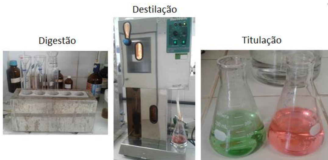
Figura 9 - Equipamentos utilizados para análise de proteínas pelo método de Kjeldahl. Digestão (forno de digestão de proteínas, utilizando ácido sulfúrico), Destilação (destilador de nitrogênio, utilizando hidróxido de sódio), Titulação (gotejar ácido clorídrico até ficar rosa).
