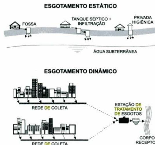
**Figura 1: Sistema de esgotamento estático e dinâmico. Fonte: VON SPERLING, 1996.**
