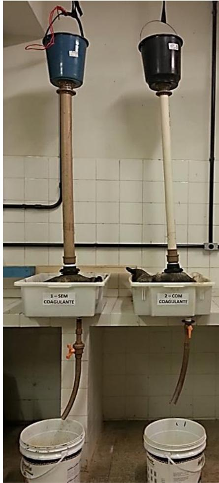
**Figura 9: Montagem experimental para realização do ensaio de deságue de lodo. Fonte: GPTA.**
