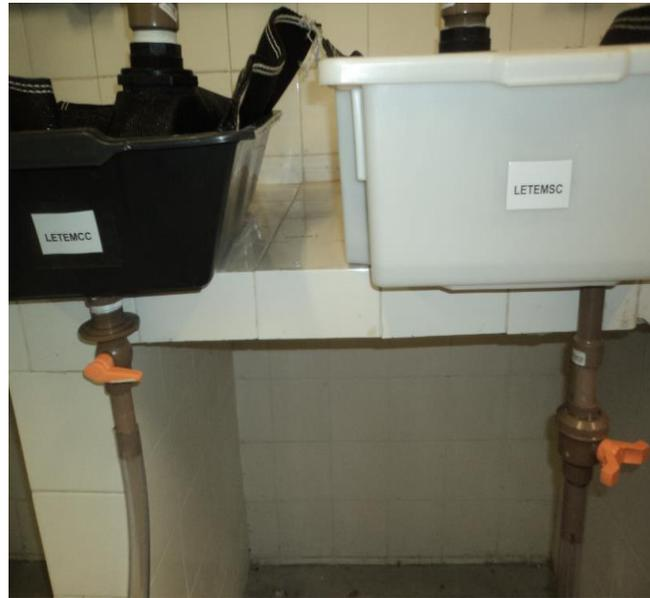
**Figura 12: Montagem dos Bags e Ponto de coleta do drenado. Fonte: GPTA.**
