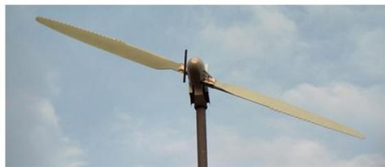
**Figura 8** - Inspiração na nadadeira da Jubarte, maior eficiência. A empresa Whale Power Corporation teve inspiração nas barbatanas da Jubarte. Aplicação em hélices, escalonamento de redução de 32% no arrasto e melhora de 8% no impulso. Fonte: BIOMIMICRY.NET, 2014.
