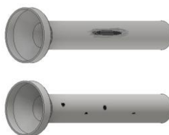
Figura 2.2e: Pontos de corrosão e furos de ruptura
