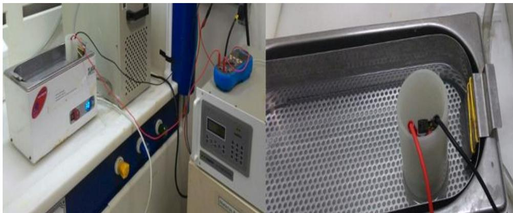
**Figura 3. 1** - Sistema de anodização.
