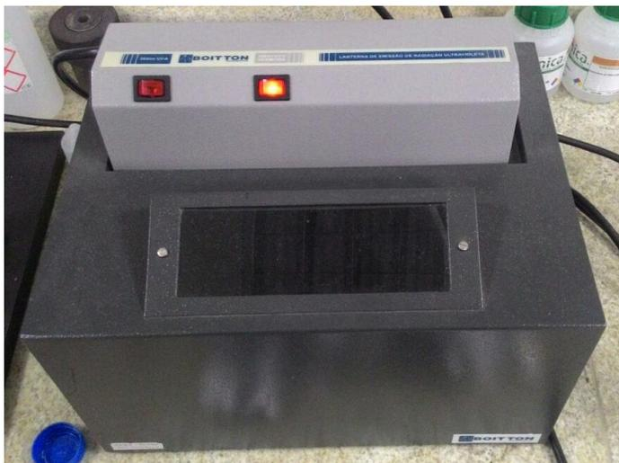
**Figura 3. 2** - Câmara de Radiação (lanterna de emissão de radiação ultravioleta modelo BOIT-LUB01).
