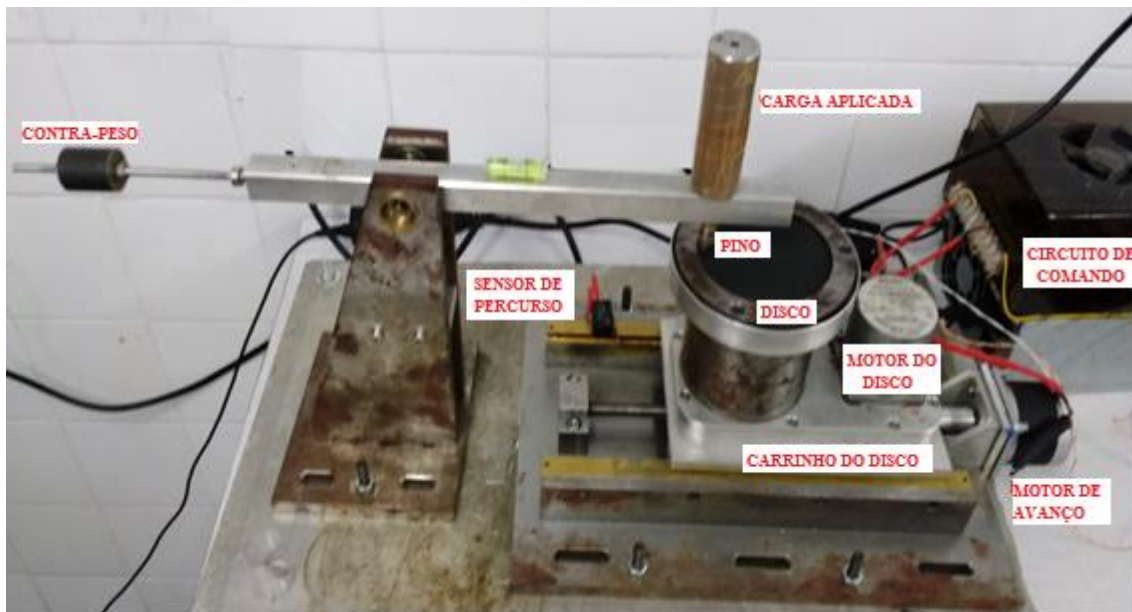
Figura 3.16 Dispositivo para estudo de desgaste do tipo pino no disco e seus componentes.
