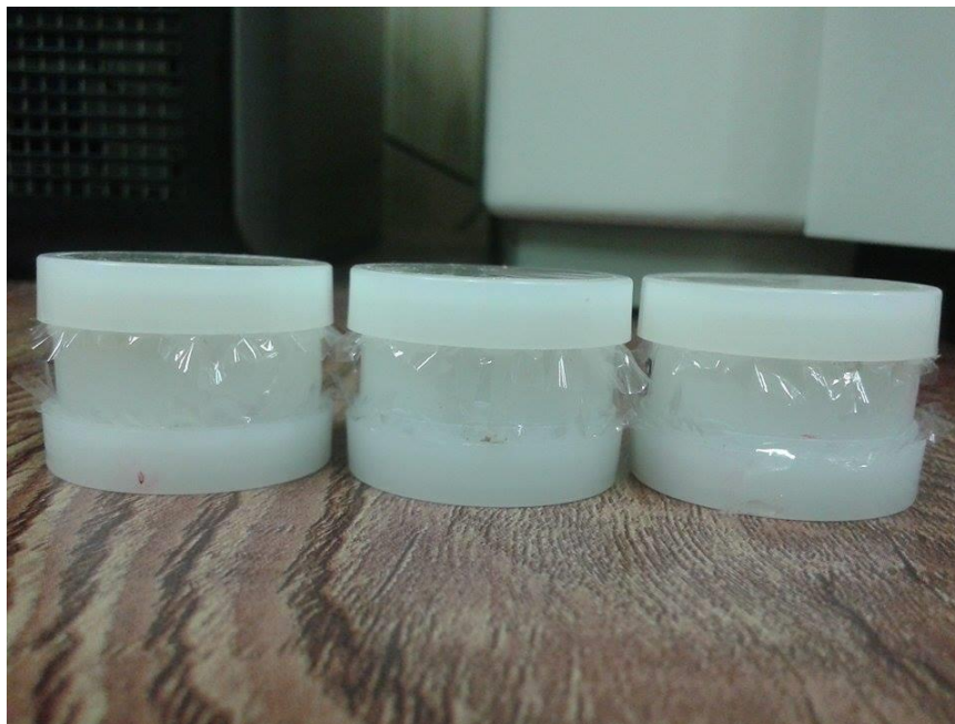
Figura 12 – Cápsulas de polietileno vedadas com filme de polipropileno para análises no EDXRF
