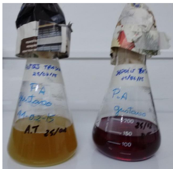
Figura 23. Resultado da inoculação em caldo Lauril Tryptose, antes (à esquerda) e depois do tratamento (à direita). Os ensaios após o tratamento foram realizados com amostras resultantes de tratamento no “setpoint” de 85 °C.
