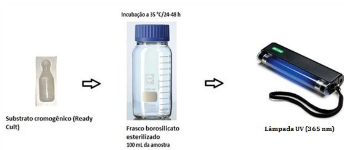
Figura 10. Esquema de análise para confirmação de coliformes termotolerantes e E. coli .
