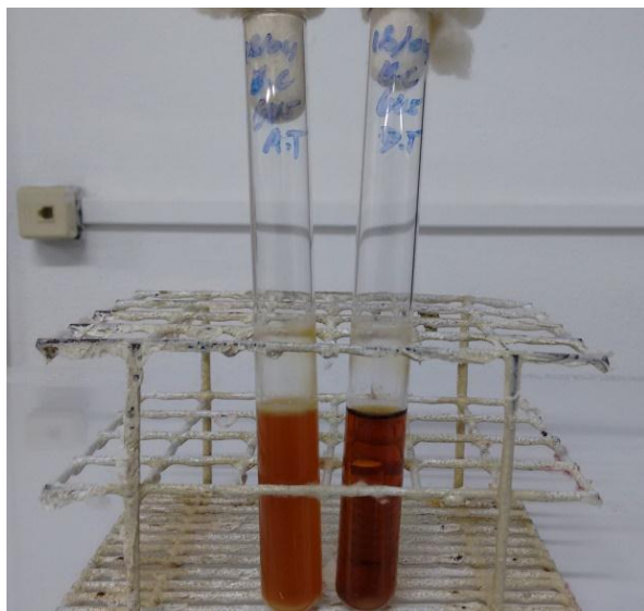
Figura 25. Resultado da inoculação em meio EC, antes (tubo à esquerda) e depois do tratamento (tubo à direita).
