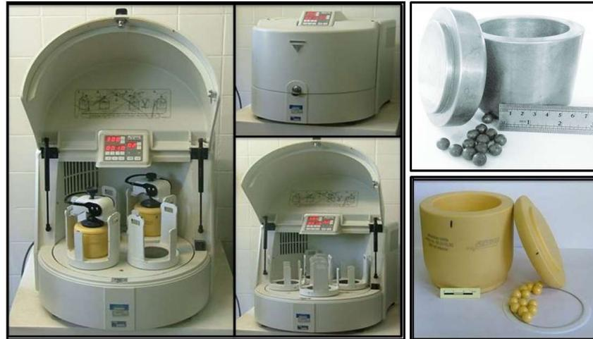
Figura 15 – Moinho planetário *Fritsch P-5* (lado esquerdo); potes e bolas de aço (lado superior direito) e potes e bolas de zircônia (lado inferior direito) utilizados nos ensaios de moagem com calcário e quartzo, respectivamente (adaptado de SOARES, 2013).
