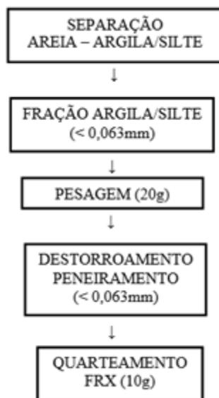
Figura 14 - Fluxograma: preparação de amostras para ensaio de FRX.
