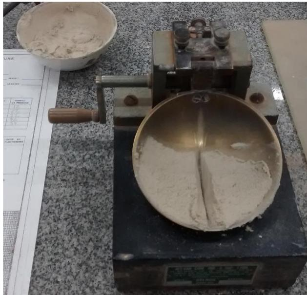
Figura 19 - Aparelho de Casagrande com material para ensaio.
