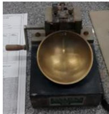
Figura 5 - Aparelho de Casagrande.
