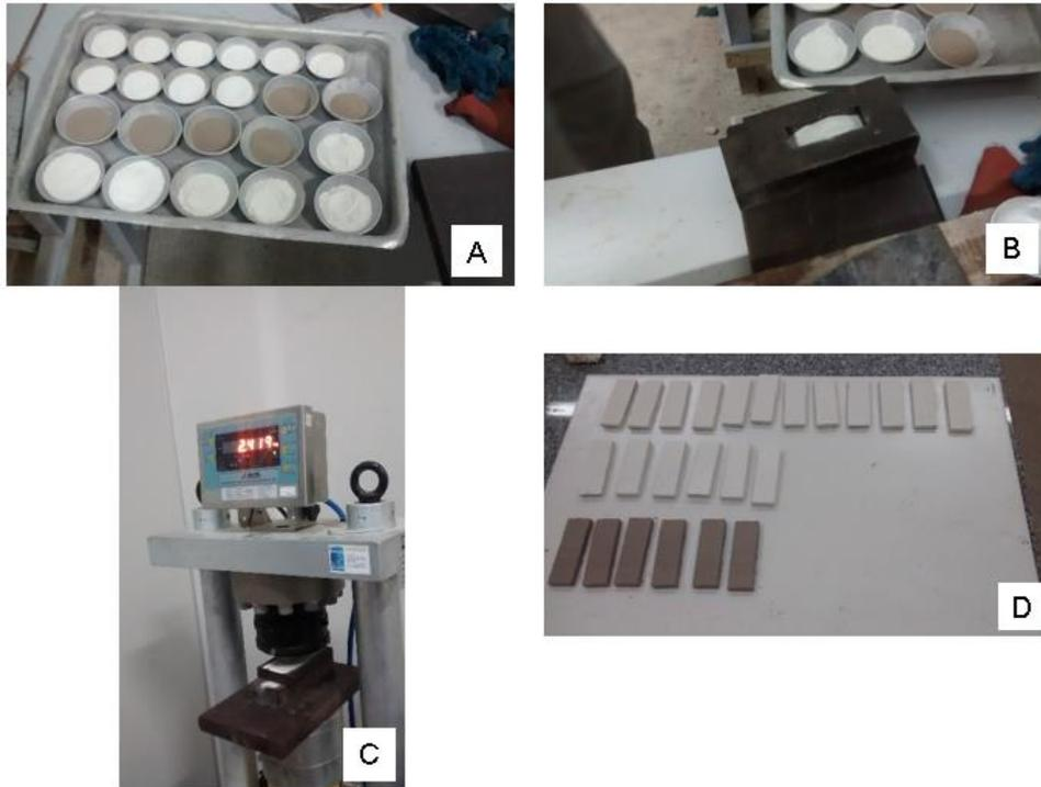
Figura 21 - (A) porções de argila (13g); (B) molde de metal; (C) prensa hidráulica; (D) Corpos de prova.
