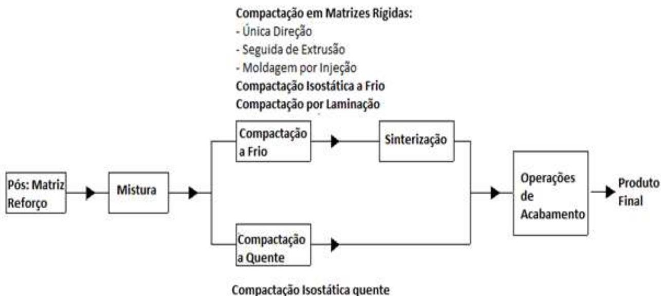
A rota da metalurgia do pó é econômica, rápida e permite a produção em grande escala. Os produtos obtidos podem apresentar alto desempenho, uma distribuição homogênea do reforço na matriz e excelente controle microestrutural. Oferece também grande flexibilidade em termos de tamanho e fração de partículas de reforços cerâmicos (Gomes, 1995).
