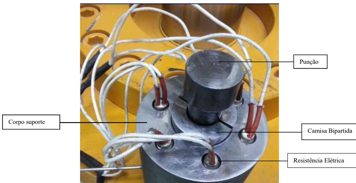
O projeto deste conjunto, cujo detalhes internos são apresentados na figura 32, se deu a partir das forças necessárias a extrusão das amostras, do volume para se obter um tarugo consolidado na qual se pode verificar as propriedades mecânicas, bem como da potência elétrica utilizada no aquecimento das resistências.
