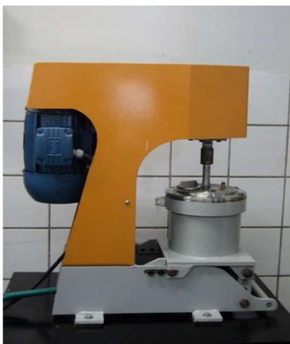
O movimento das esferas em conjunto com a carga dos pós foi realizado por hastes horizontais ligadas a um eixo vertical, controlado por um variador de velocidade ABB modelo Sami GS. A temperatura foi mantida através de canais refrigerado por água. O esquema de moagem é ilustrado na figura 28.
