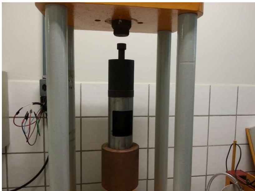
Os nanocompósitos foram compactados em pré formas de 40mm de diâmetro por 20mm de altura (compactado verde a ser extrudado), sem aquecimento, com carga de 35ton, durante 2 (dois) minutos. Podendo-se utilizar mais de um compactado verde para se obter o tamanho do tarugo desejado.
