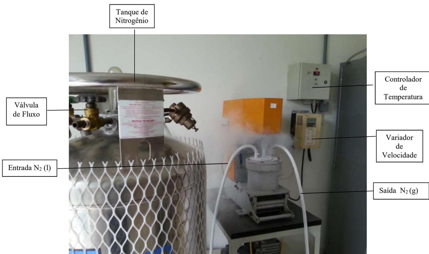
Figura 30. Esquema da moagem em baixa temperatura ou criogênica (Adaptado de Rey, 2014)
