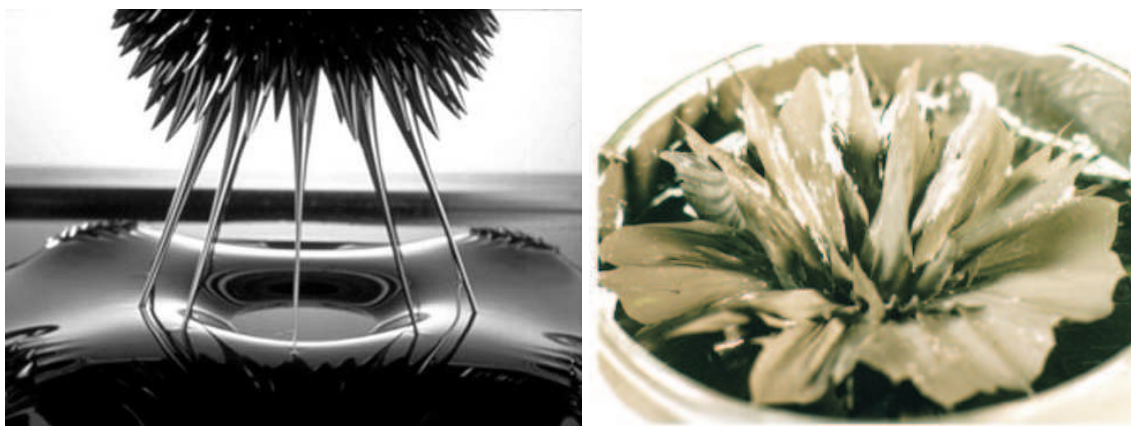
Figura 1.7 Ilustração de ferrofluido (à esquerda) [21] e fluido MR (à direita) [22], ambos sob influência de um campo magnético não-uniforme.
