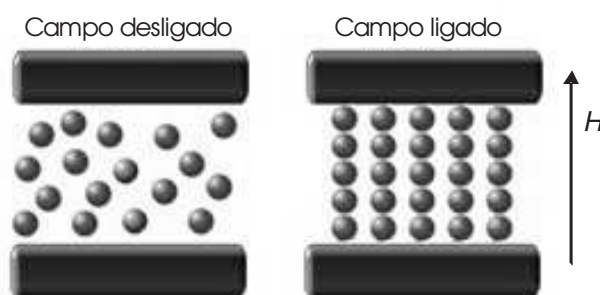
Figura 3.1 Ilustração esquemática da formação de longas cadeias e colunas de partículas num fluido MR a partir da aplicação de um campo magnético externo. As estruturas formadas exercem uma força de sustentação efetiva que resulta na propriedade de yield stress . Figura adaptada da Ref. [51].
