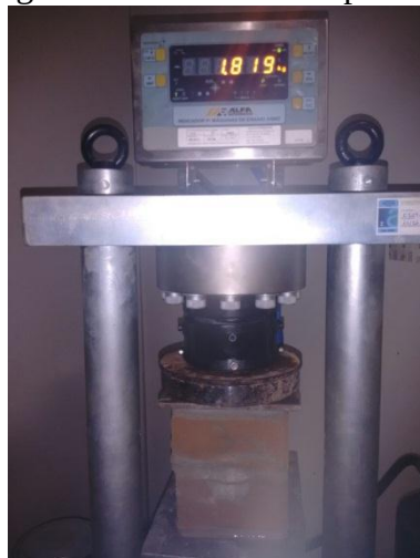
Figura 24 - Ensaio à compressão
