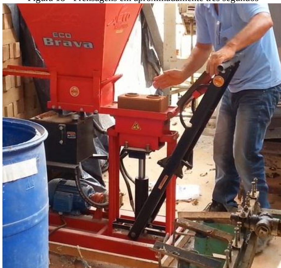
Figura 18 - Prensagens em aproximadamente três segundos
