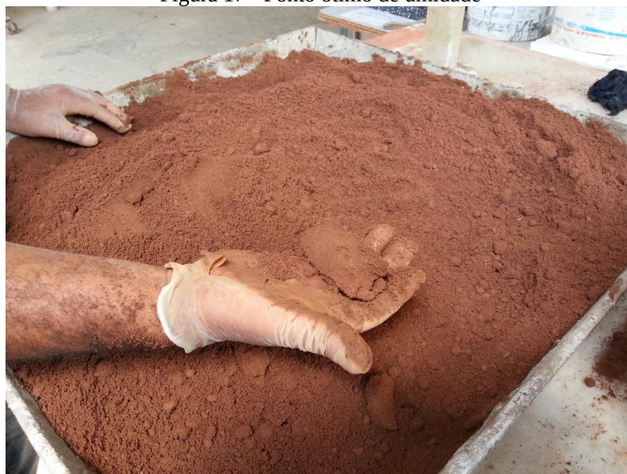
Figura 17 - Ponto ótimo de umidade
