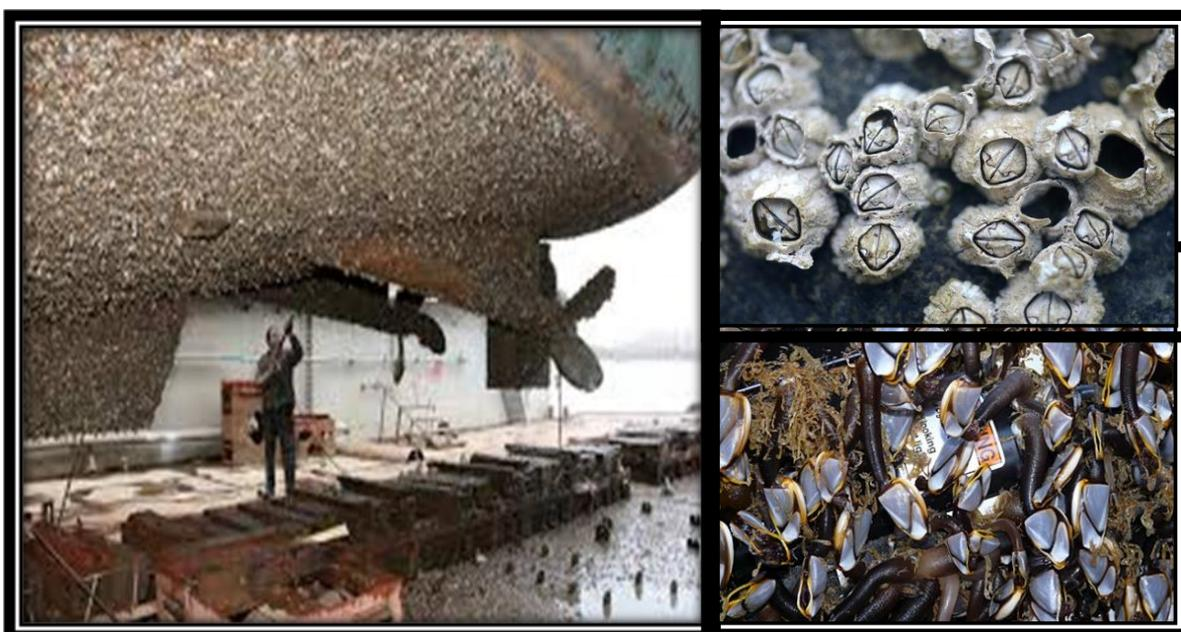
**Figura 11.** Formação de incrustações em superfície em contato com o mar. Fonte: <http://pt.dreamstime.com>.
