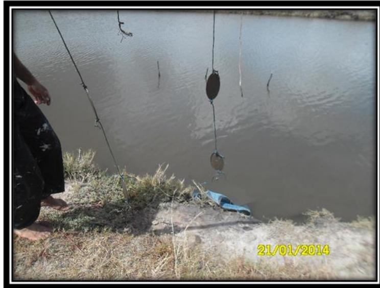
**Figura 19.** Placas com as tintas e local do teste de imersão.
