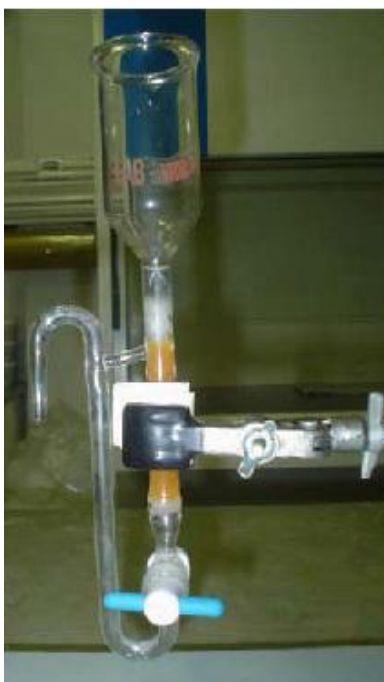
Figura 3 – Foto ilustrando detalhe da coluna de vidro de troca iônica.
