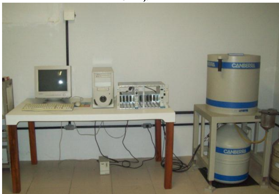
Figura 2 - Foto do sistema de medidas gama (Laboratório de Instrumentação Nuclear, DEN - UFPE).
