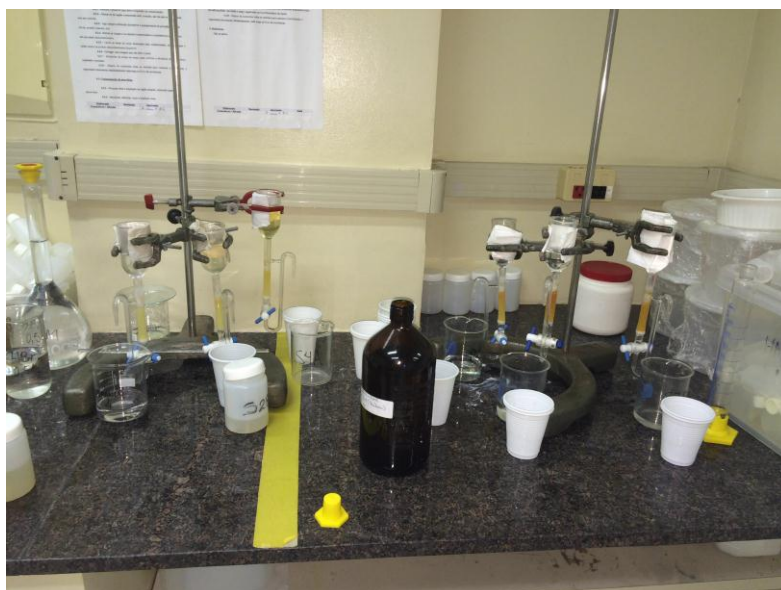
Figura 6 - Extração de ^{210}\text{Pb} pela coluna de troca iônica.
