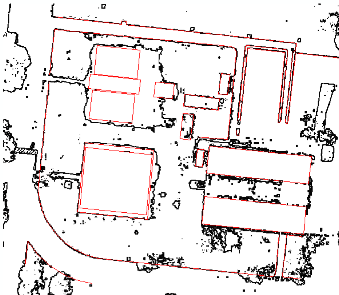
Figura 29: Representação da extração da borda gradiente com a análise visual de algumas feições da ortofoto.
