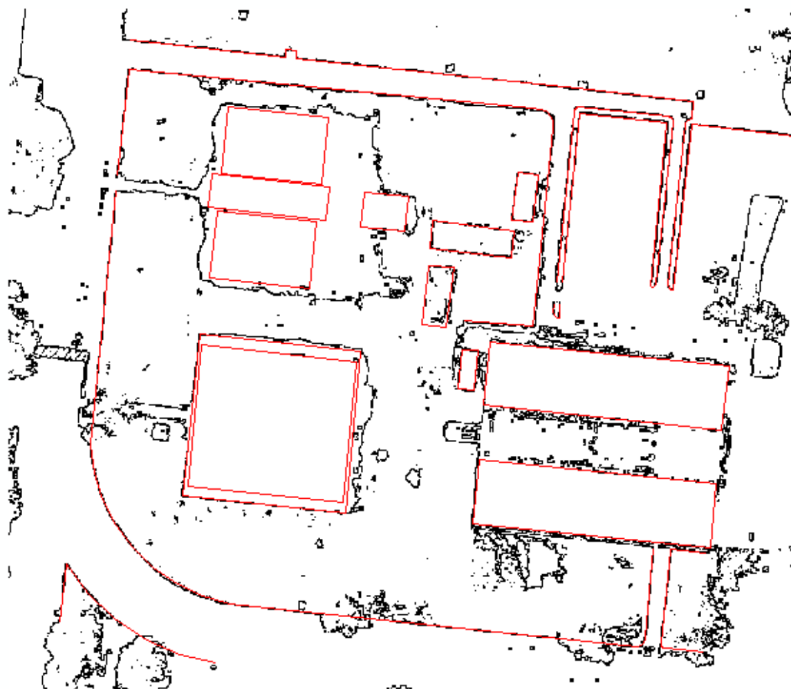
Figura 28: Representação da extração da borda externa com a análise visual de algumas feições da ortofoto.
