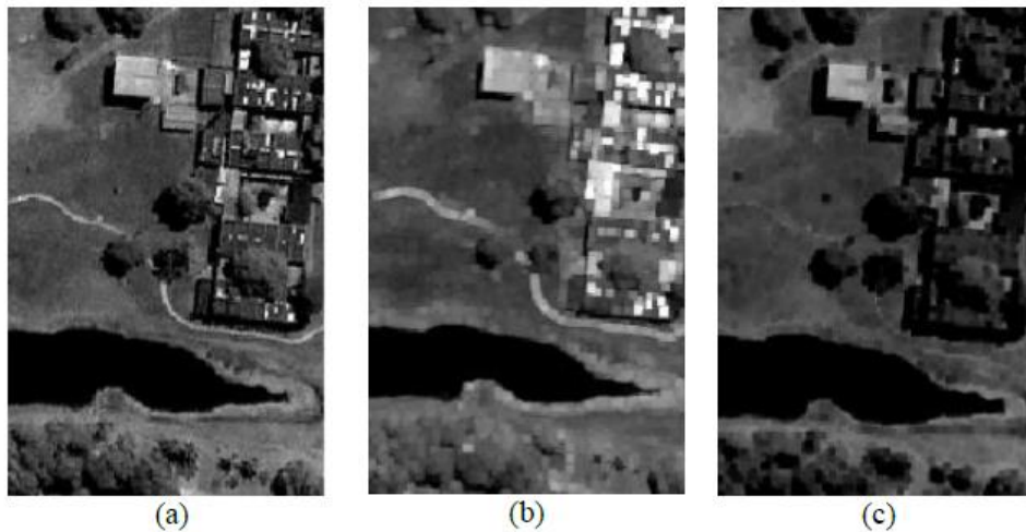
Figura 9: Operadores Básicos da MM sobre a imagem em níveis de cinza X .
