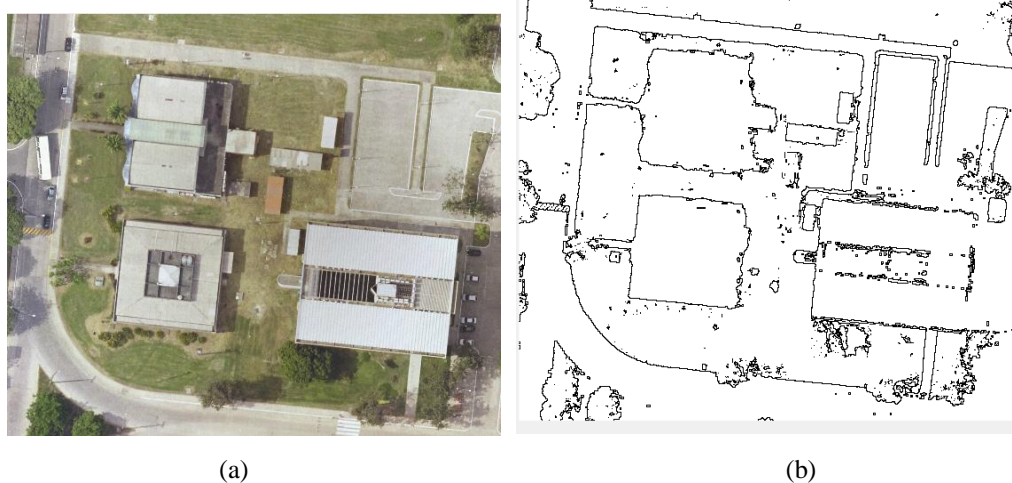
Figura 25: Representação da extração de bordas externas binarizando vegetação com HSV para imagem da ortofoto usando B_{7 \times 7} . (a) Imagem original. (b) Contorno externo da imagem binária da vegetação usando B_{7 \times 7} .
