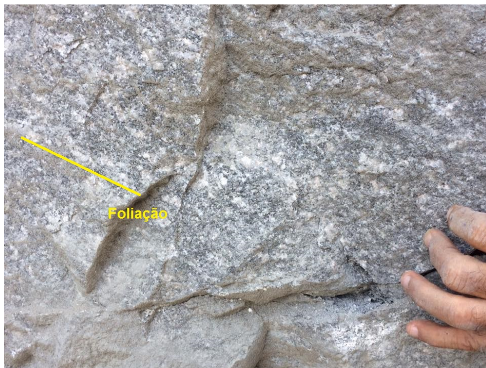
Figura 16. Foliação apresentada pelo maciço rochoso na Face Livre A1 da pedreira Combritas.
