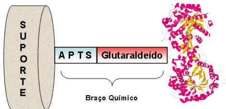
**Figura 9** Ligação Covalente: Braço químico formado pelo  $\gamma$ -aminopropiltriethylxilando que oxida, formando uma ligação covalente com suporte em altas temperaturas que por sua vez promove uma ligação alquilamida com o glutaraldeído que une-se a enzima (no esquema invertase) através da formação de bases de Schiff.
