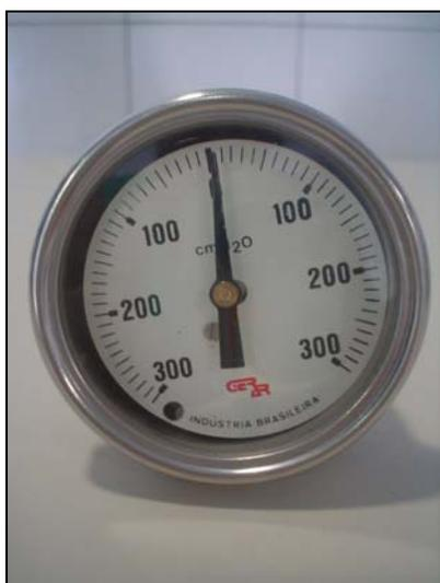
**Figura 2.** Manuvacuômetro da marca GE-AR, fabricado no Brasil, utilizado para as avaliações realizadas em solo e sob imersão.
