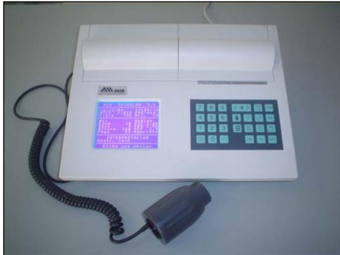
**Figura 1.** Espirômetro da marca MIR (Medical Internacional Research) fabricado em Roma, Itália, utilizado nas avaliações realizadas em solo e sob imersão.
