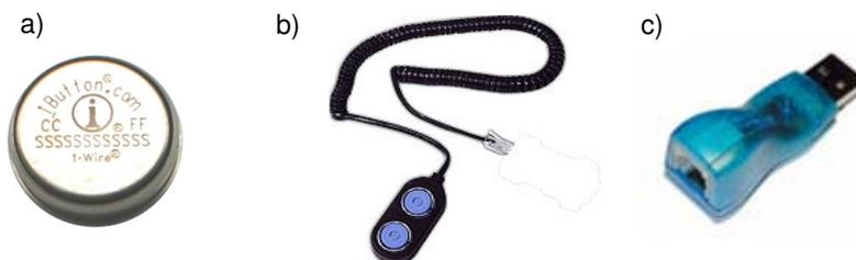
**Figura 8.** Componentes do sistema de aquisição da temperatura corporal: a) iButton®; b)Receptor DS1402D-DR8 Blue Dot; c) Adaptador DS9490R.
