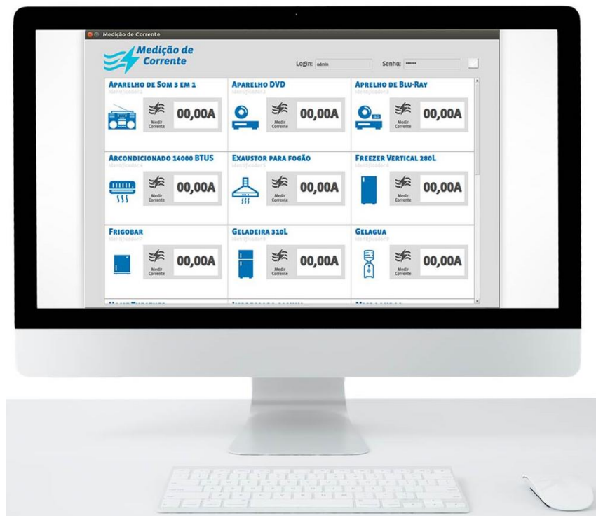
Figura 34 - Interface do programa do medidor de corrente com os equipamentos elétricos cadastrados
